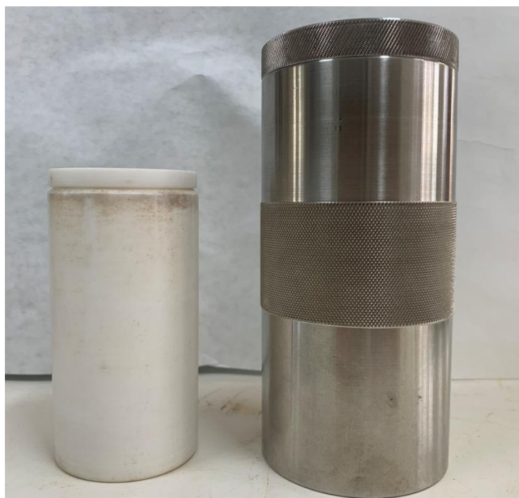
Figura 14: Reator de aço inoxidável com cápsula de teflon utilizado no processo de sulfonação.
