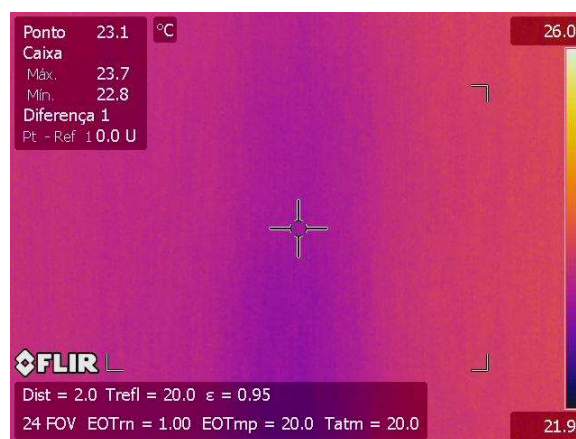
Figura 330.d - TM.P.U – Termográfica junta do encabeçamento
