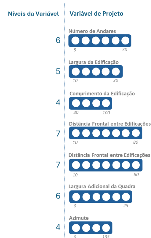
Figura 30 – Variáveis morfológicas de projeto e seus níveis para tipologia de quadra com edificação em fita
