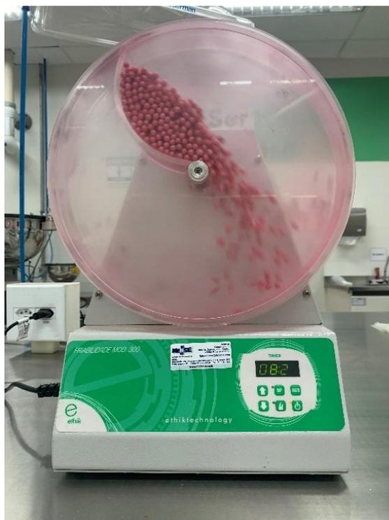
**Figura 2** – Friabilômetro em operação para o teste de abrasão. Brasília-DF, 2023.
