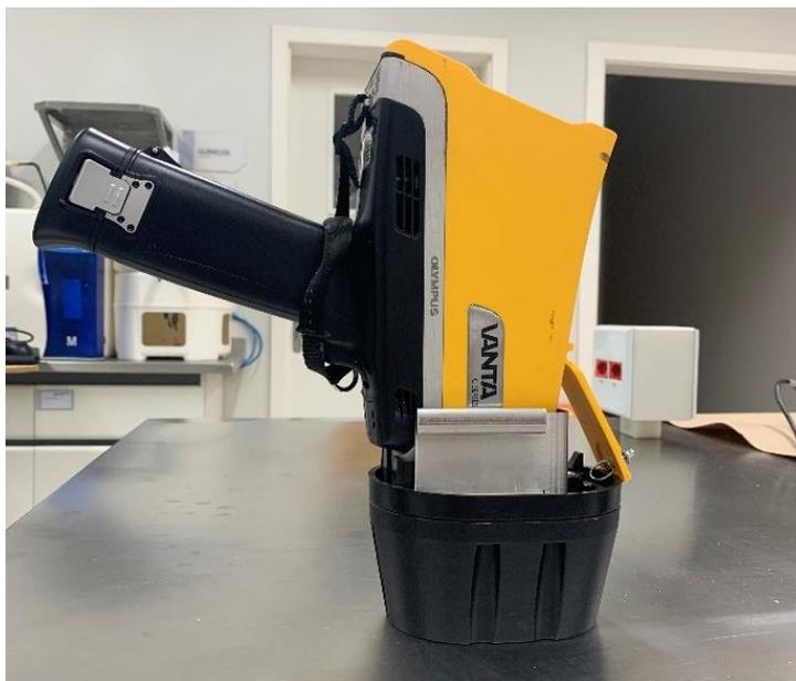
**Figura 3** – Analisador XRF, modelo Vanta™. Brasília-DF, 2023.
