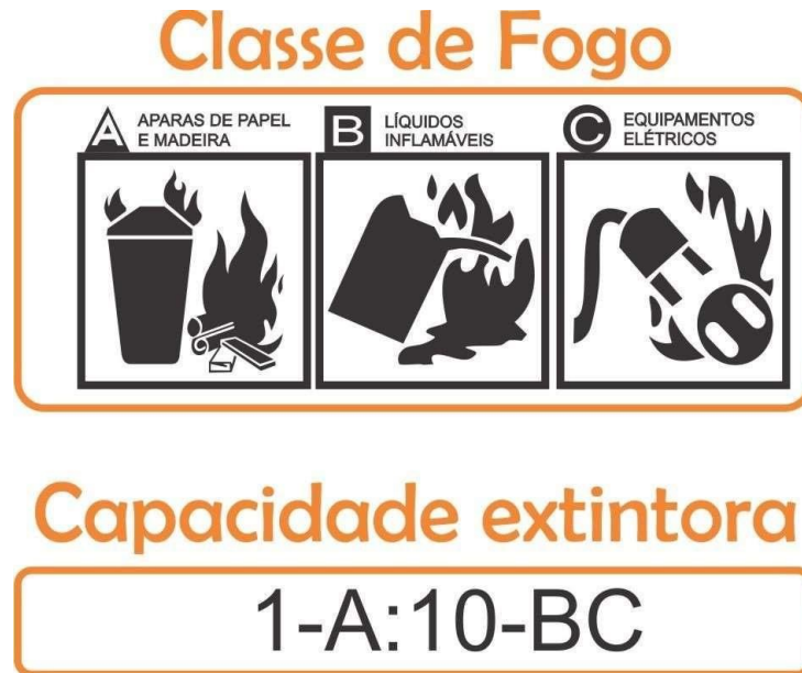
Figura 23: Pictogramas que indicam classe de fogo (ou incêndio) e capacidade extintora. Fonte: Site do CBMDF.
