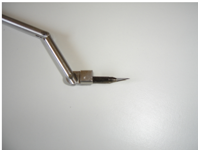
Figura 2 – Microlâmina e haste metálica articulada, destinadas a bipartição e microsecção de embriões.
