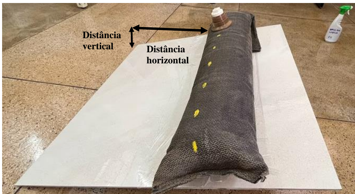
Figura 3.13. Obtenção do valor do coeficiente de atrito estático máximo pelo ângulo
