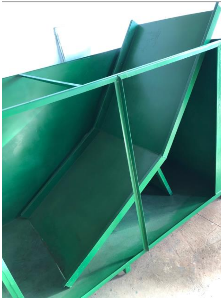
Rampa segmentada – a inclinação foi ajustada nos ensaios para 30^\circ + 60^\circ
