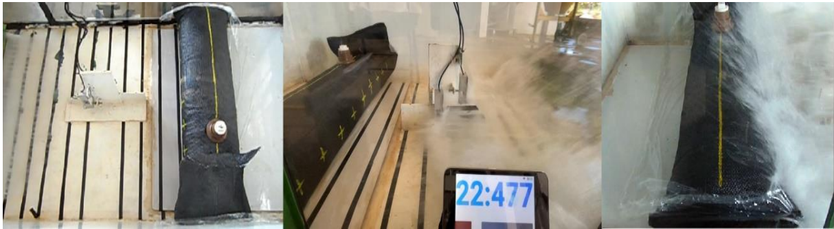
Figura 3.17. Realização do ensaio com percurso do fluxo turbulento e da onda de impacto.
