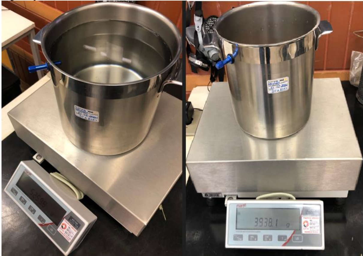
Rice Test: peso da panela e da panela com água destilada
