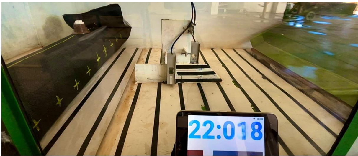
Configuração das células, cronometro, marcos de distância e profundidade
