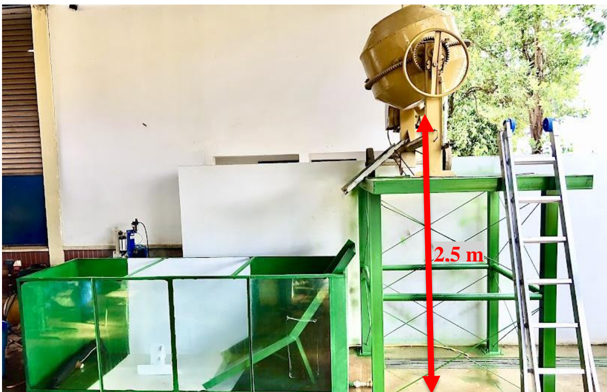
Figura 3.6. Canal hidráulico, rampa segmentada e torre com a betoneira
