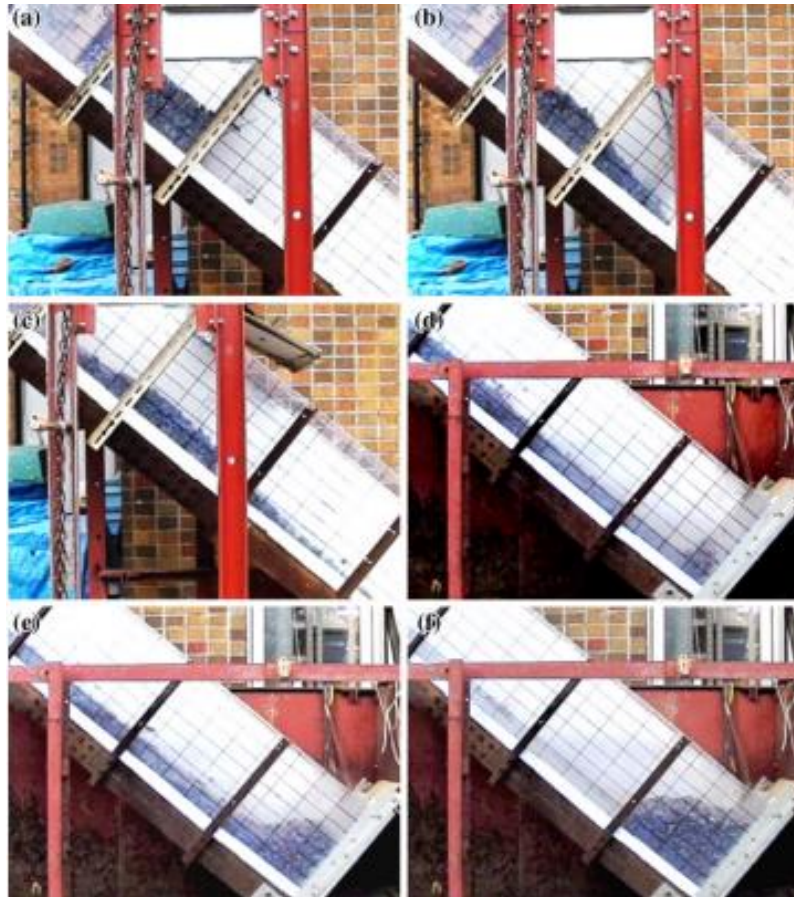
Figura 2.20 Canal elaborado por Jiang e Towhata (2012) para o estudo experimental de fluxo granular seco e do comportamento de impacto contra um muro de contenção rígido
