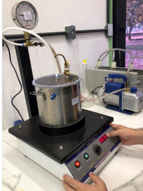
Figura 3.10. Determinação da densidade real dos grãos
