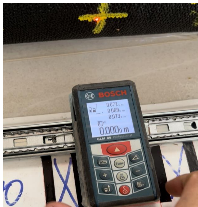
Figura 3.18. Obtenção das medidas de deslocamento das barreiras
