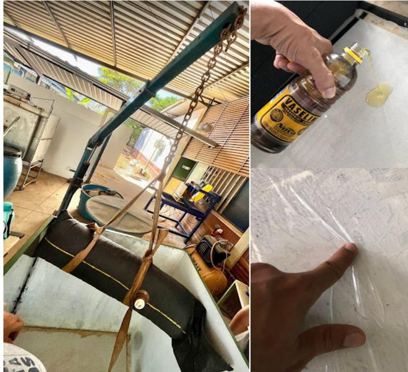
Figura 3.12 Colocação / retirada do tubo do canal e aplicação de vaselina e do filme de PVC
