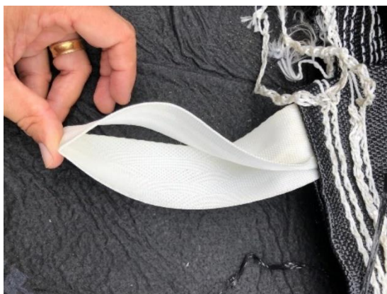
Figura 4.14. Elemento de fixação de extremidade do tubo geotêxtil
