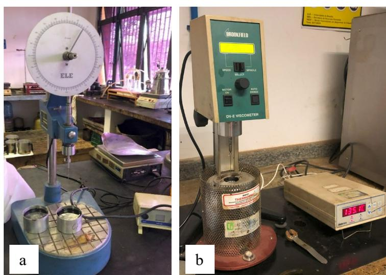
Figura 3.6. a) Penetrômetro e b) Viscosímetro *Brookfield*.
