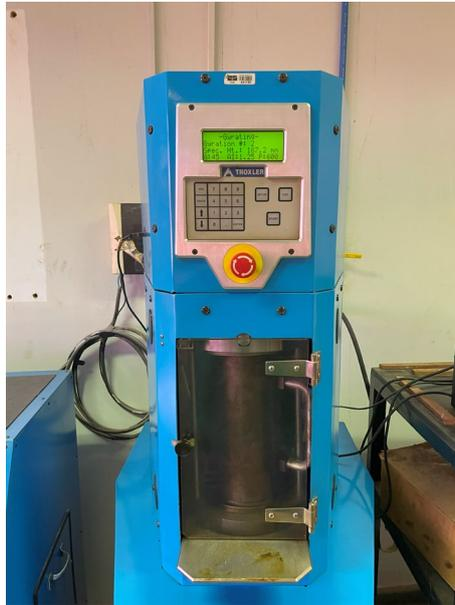
Figura 3.8. Compactador giratório utilizado para confecção dos corpos de prova.
