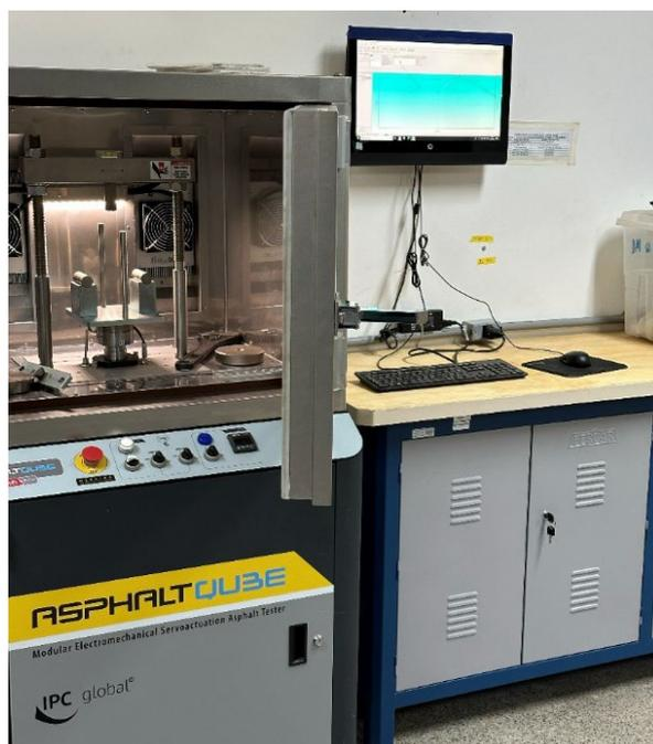
Figura 3.14. Equipamento de ensaios modular do tipo eletromecânico servoatuador - *AsphaltCube*
