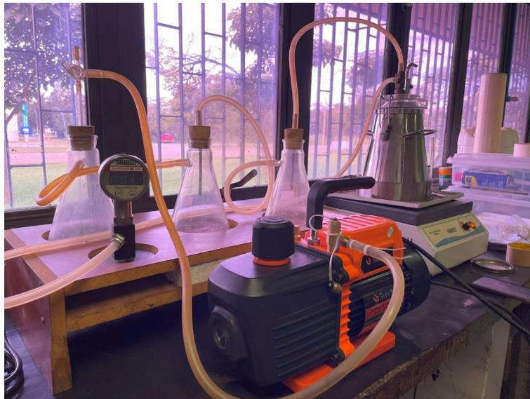
Figura 3.11. Conjunto de *Rice Test* utilizado para determinação de massa específica máxima da mistura.
