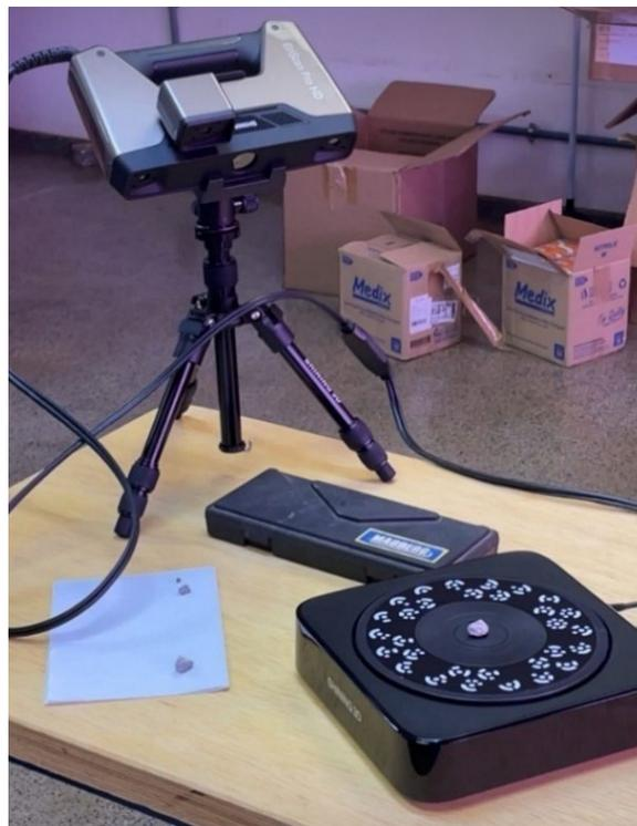
Figura 3.5. Escaneamento 3D de agregado com utilização do Scanner DAVID-3D.
