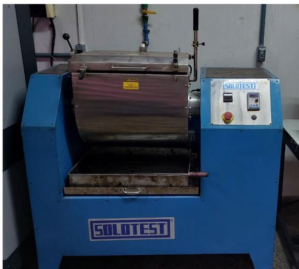
Figura 3.10. Misturador mecânico para homogeneização dos materiais
