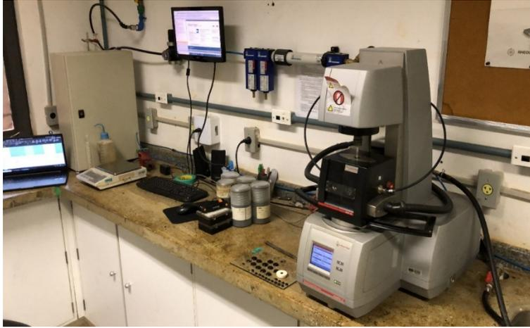
Figura 3.7. Reômetro de cisalhamento dinâmico (DSR).
