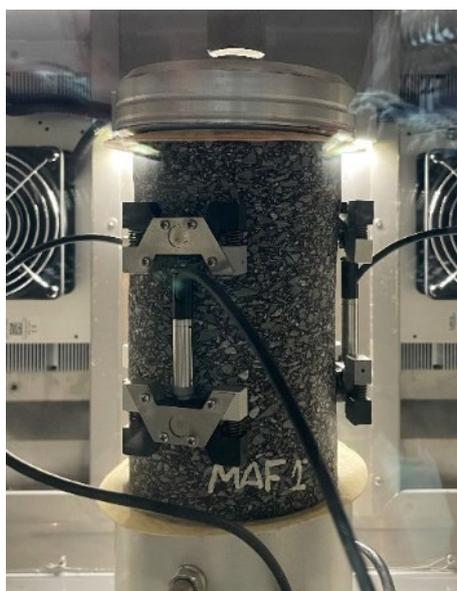
Figura 3.15. Corpo de prova posicionado para realização do ensaio de Módulo Dinâmico.
