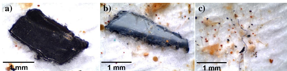
Figura 6.15- Exemplos de MPs encontrados no lodo químico para 40 g de amostra: a) fragmento preto; b) fragmento branco e c) fibra azul e fragmentos diversos.
