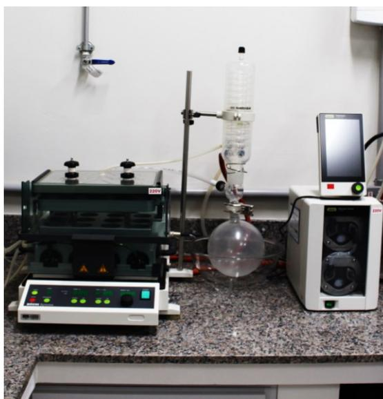
Figura 13 – Evaporador e Bomba de vácuo com interface de operação
