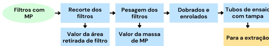
Figura 9 – Representação esquemática da preparação dos filtros
