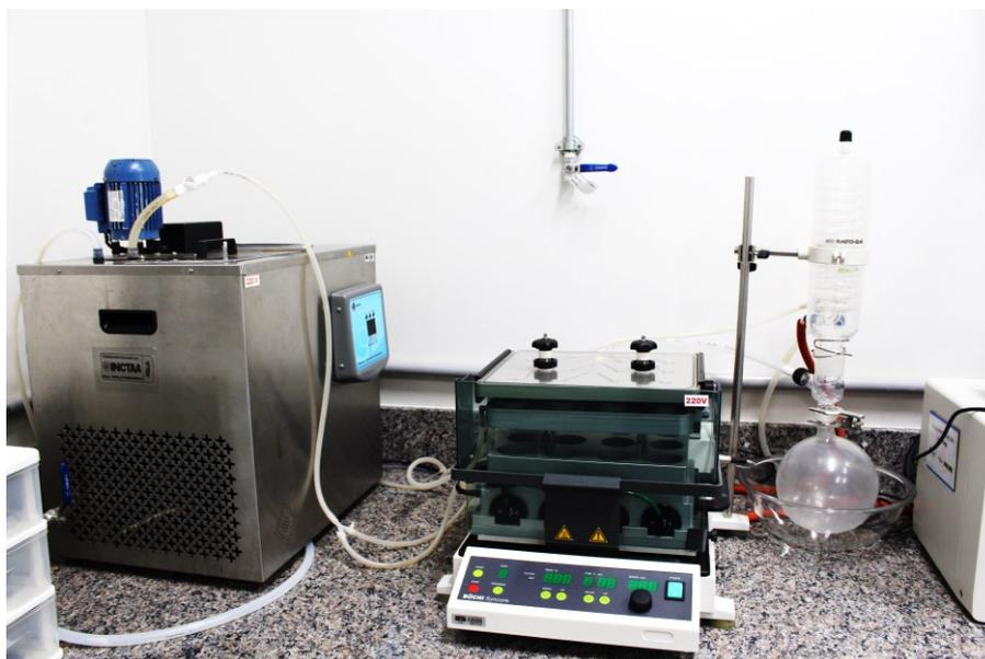
Figura 12 – Sistema de evaporação Buchi Syncore Analyst
