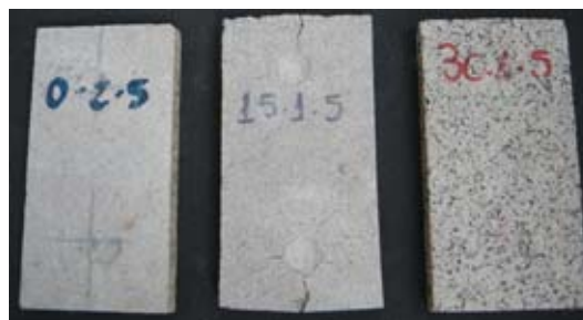
Figura 4.26 - Compósitos cimento-madeira-borracha após ensaio de dureza Janka.
