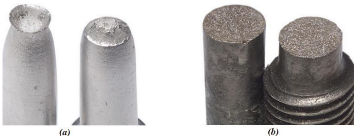
Figura 2.7. (a) Fratura do tipo taça e cone no alumínio. (b) Fratura frágil em um aço doce (Callister e Rethwisch, 2016).
