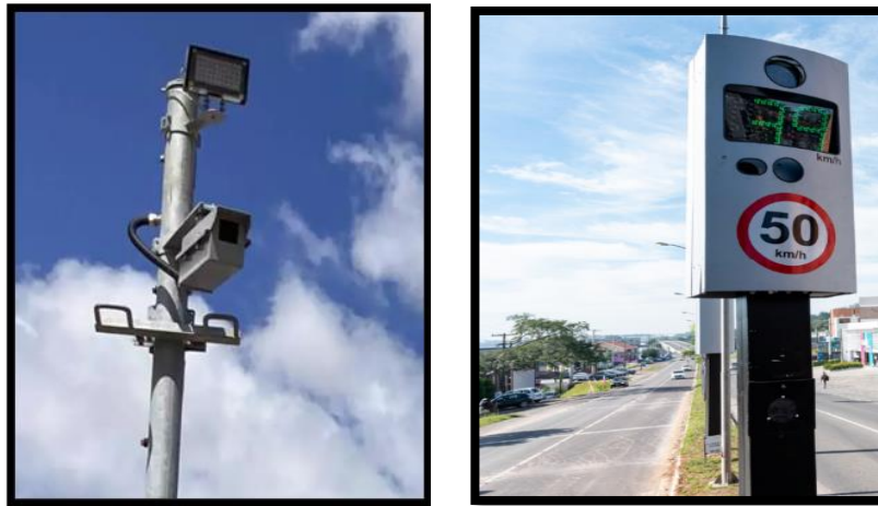
(a) Controlador de velocidade (b) Redutor de velocidade
