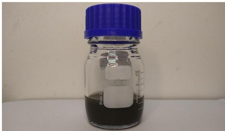
**Figura 9** – Suspensão de 2H-MoS<sub>2</sub> após a centrifugação e coleta do sobrenadante.
