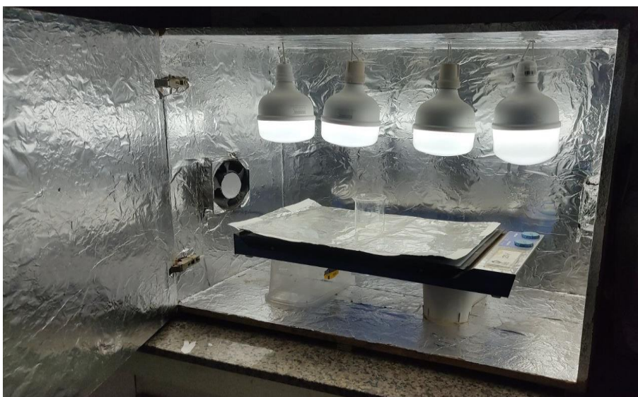
Figura 8. Câmara fotocatalítica constituída de: uma caixa de isopor revestida com papel alumínio; placa de agitação; duas ventoinhas para circulação de ar; e quatro lâmpada de LED de 50W de luz branca fria (6500K).
