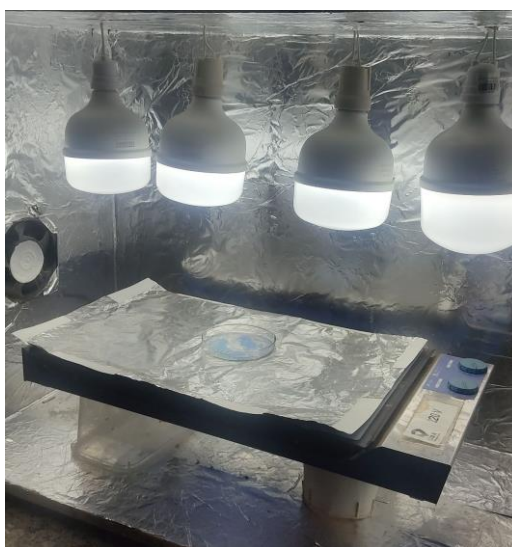
Figura 59. Fotodegradação na câmara fotocatalítica do azul de metileno adsorvido no g-C_3N_4 .
