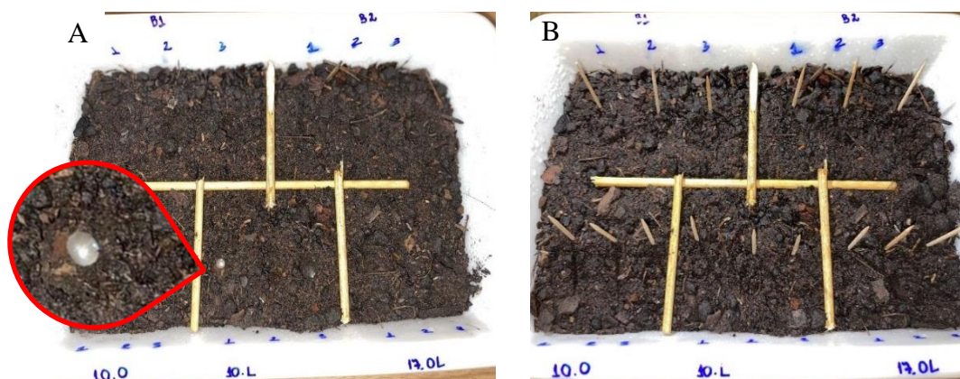
Figura 27 - (a) Filmes posicionados na bandeja; (b) filmes enterrados com posições marcadas
