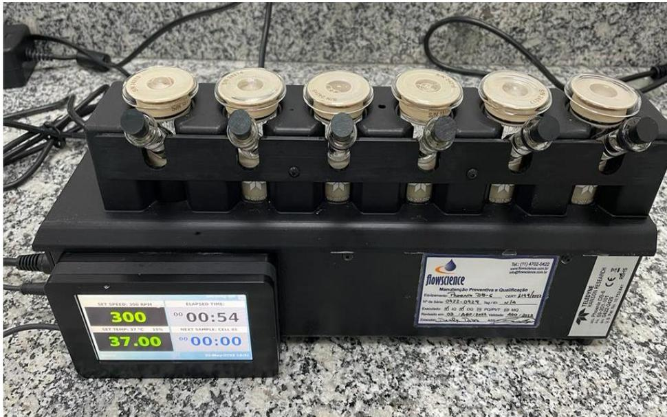
Figura 10. Células de difusão acopladas a um equipamento com sistema de aquecimento a seco, Hanson®
