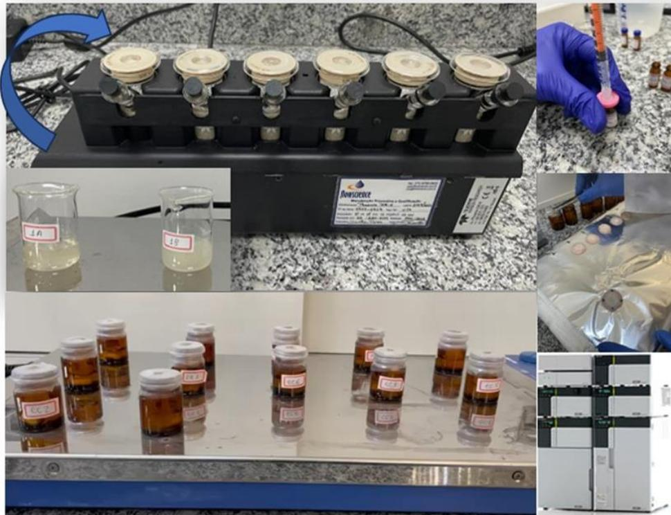
Figura 11. Técnica do estudo de permeação in vitro com auxílio do equipamento Hanson<sup>®</sup>, realizado coleta do meio extrator, *tape stripping* e filtração após 24h para injeção no HPLC.
