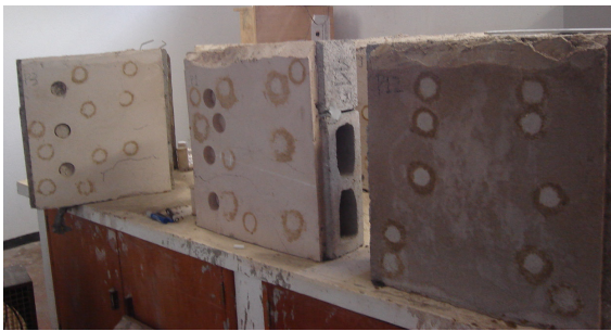
Foto 4.2 – Vista dos painéis de bloco de concreto com argamassa aplicada.
