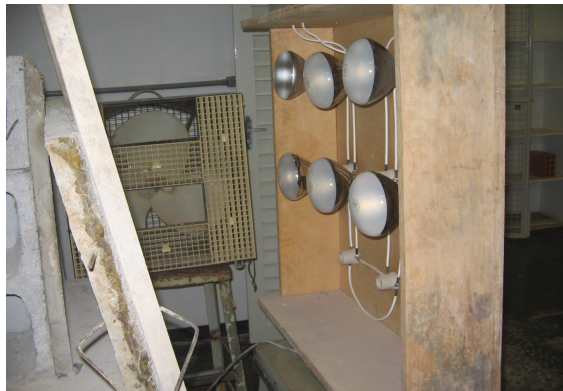
Figura 4.9 – Vista do painel térmico e do ventilador.
