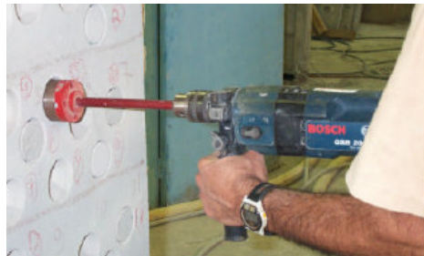
Figura 4.13 – Vista do ensaio de corte com a serra-copo.
