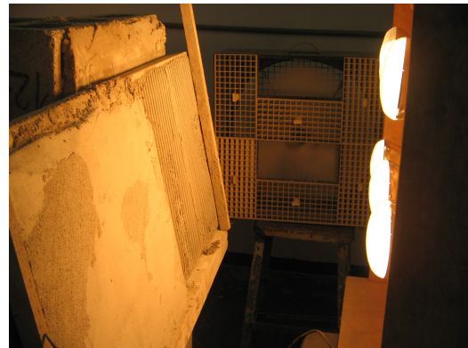
Figura 4.10 – Aplicação da carga térmica e do efeito de vento.
