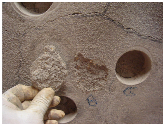
Foto 4.10 – Formato de ruptura do CP.
