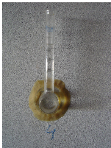
Foto 4.4 - Vista lateral do ensaio do cachimbo.
