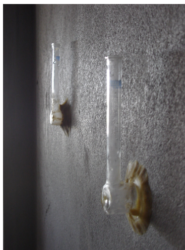
Foto 4.5 - Vista frontal do ensaio do cachimbo.
