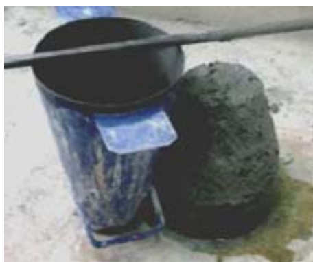
Figura 4.11 Tronco-cone e etapa do ensaio de abatimento em concreto.
