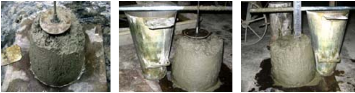
Figura 4.12 Equipamento e etapas do ensaio de abatimento modificado em concreto.
