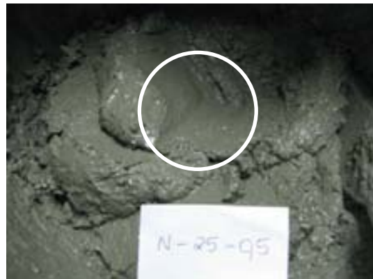
(d) exemplo de argamassa plástica: Retenção da forma sem ruptura
