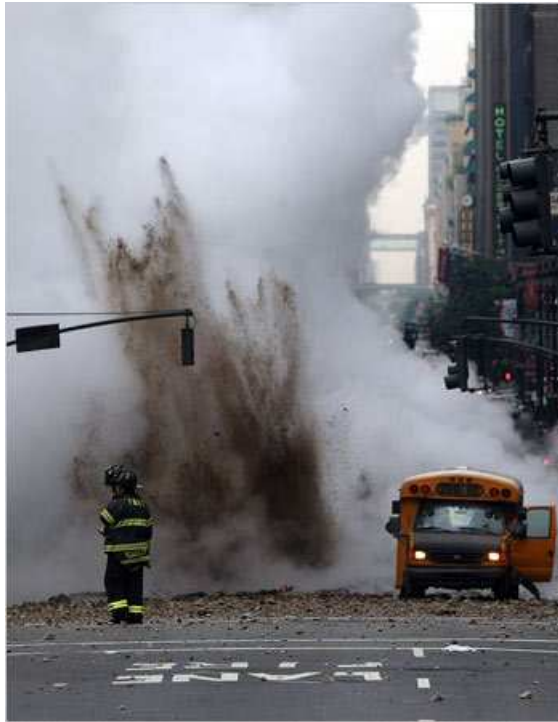
Figura 1.3: Ruptura de linha de transporte de vapores e condensados em New York (2007). Fonte: Thermgard (2009)
