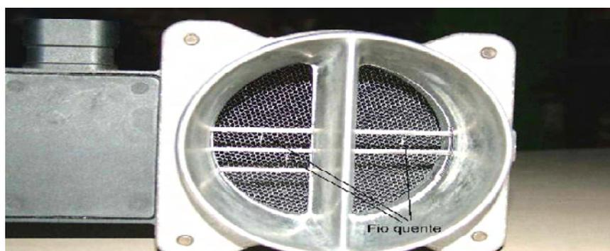
**Figura 31 – Sensor de vazão mássica**
