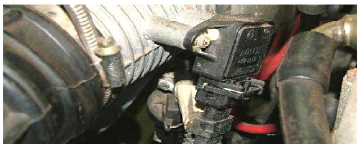
Figura 38 – Potenciômetro sensor da posição da borboleta de aceleração
