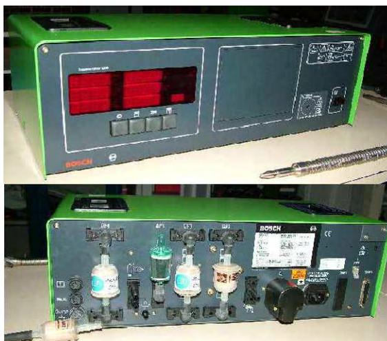
**Figura 56 – Analisador de gases.**
