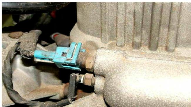
**Figura 37 – Sensor de temperatura da água do motor**
