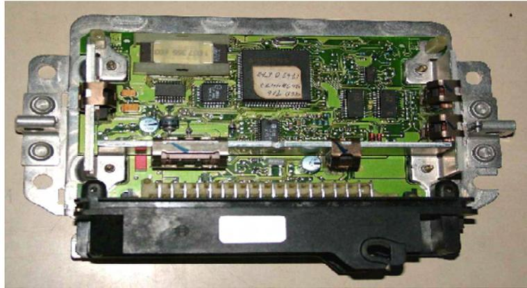
**Figura 49 – Central eletrônica de gerenciamento do motor Bosch Motronic.**
