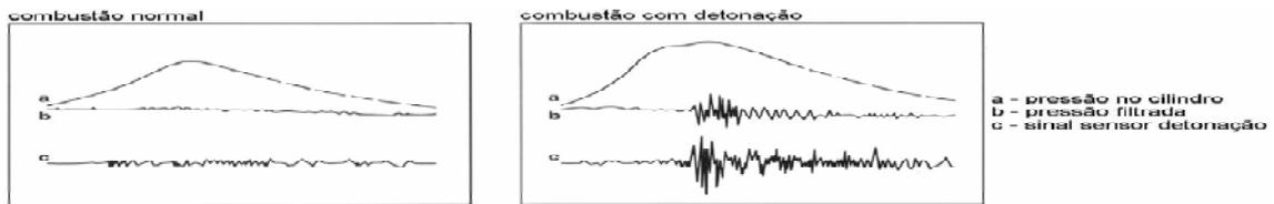
**Figura 39 – Sinais do sensor de detonação x pressão no cilindro - (BOSCH, 1999)**
