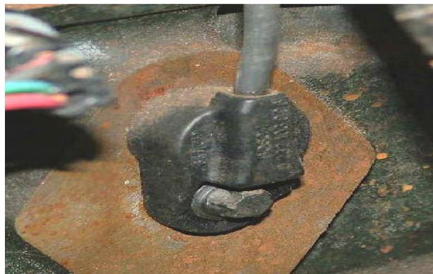
**Figura 34 – Sensor de fase do motor**
