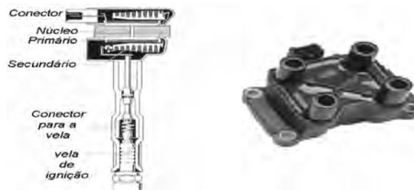
**Figura 45 – Bobinas de ignição – (BOSCH, 1999)**
