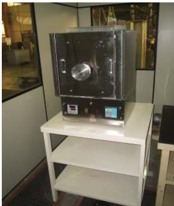
Figura 3.6 Forno FE1600-INTI utilizado nesse estudo.
