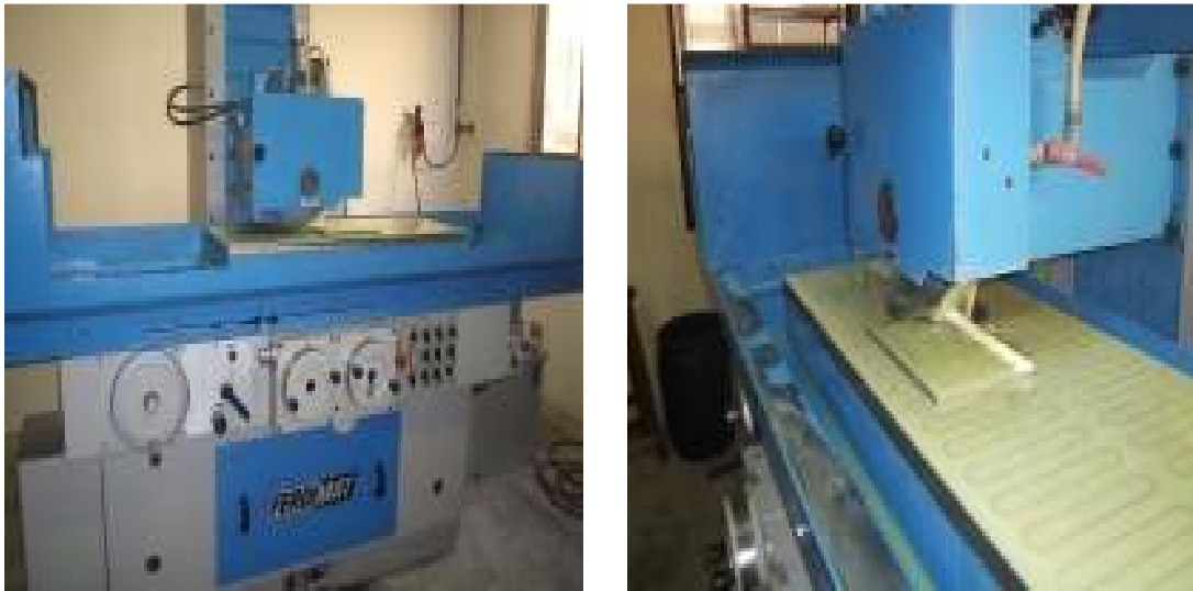
Figura 3.7 Retífica automática utilizada para preparação superficial das amostras sinterizadas.
