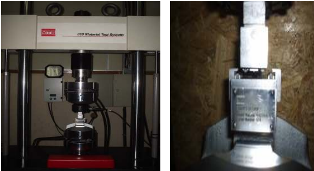
Figura 3.12 Máquina Universal de Ensaio com adaptador para Fadiga a Flexão – USP-EEL-Demar. À direita fotografia do Kit para ensaios de flexão/fadiga.
