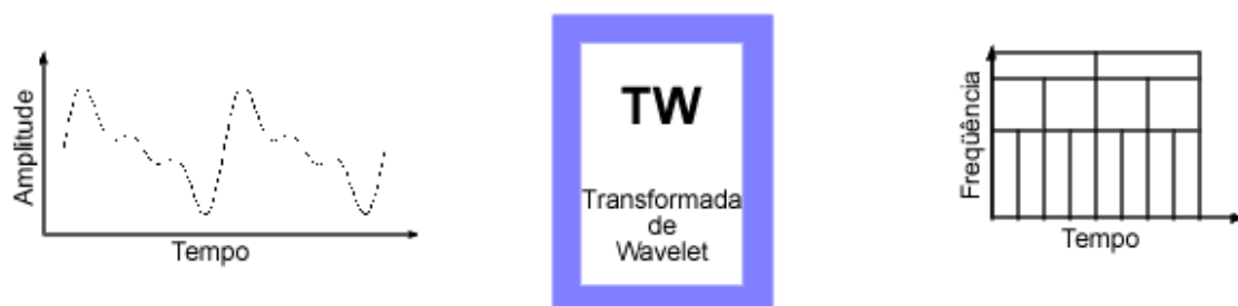
Figura 3.2 – Resolução no plano tempo-frequência obtida pela Transformada de Wavelet (modificado – MATLAB).
