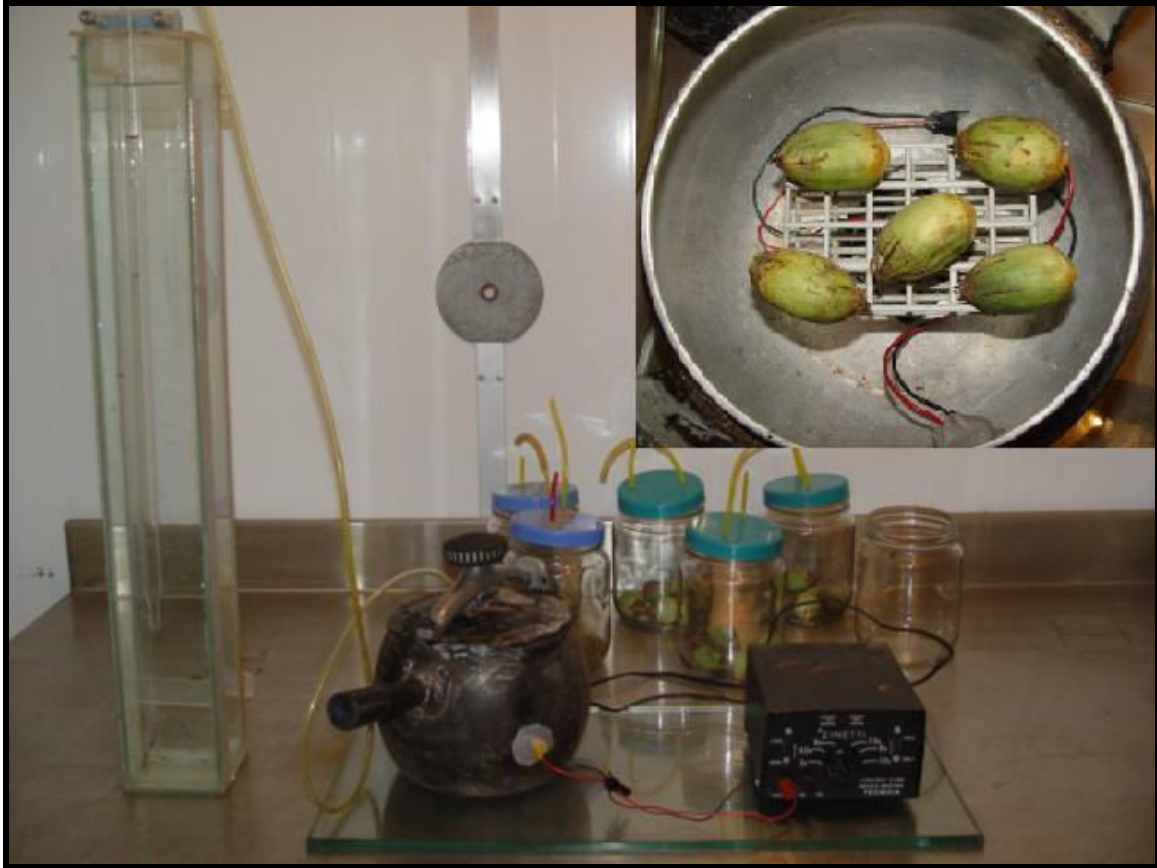
Figura 5 – Porômetro pós-colheita montado para a realização dos experimentos. No detalhe, disposição dos frutos de gueroaba ( Syagrus oleracea ) antes do fechamento da câmara do porômetro.
