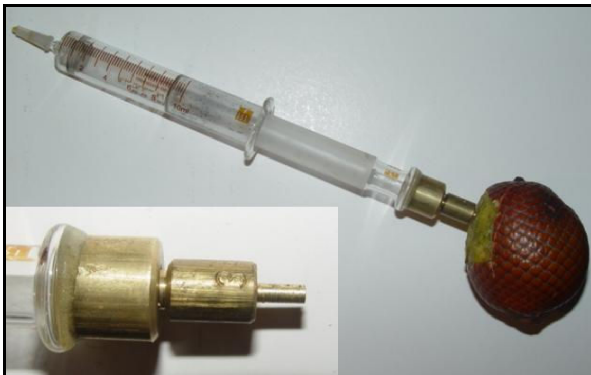
Figura 4 – Penetrômetro a gás utilizado no experimento com frutos de buriti ( Mauritia vinifera ) e detalhe da ponta de prova escolhida para a realização das medições.
