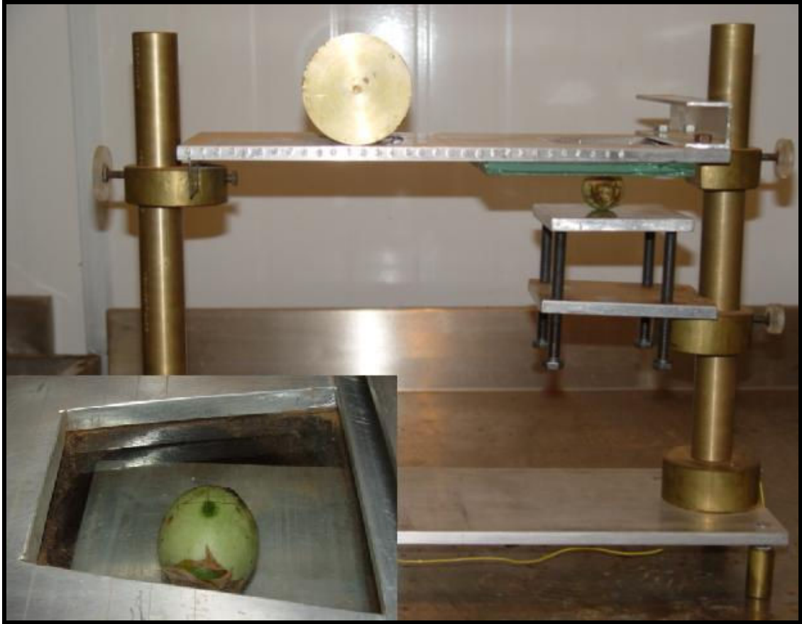
Figura 3 – Aplanador utilizado durante o experimento. No detalhe observa-se a elipse formada na área amassada em fruto de gueroba ( Syagrus oleracea ).
