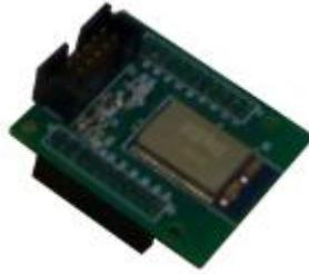
Figura 2.11 – Breakout com ZigBit (MeshNetics, 2008).
