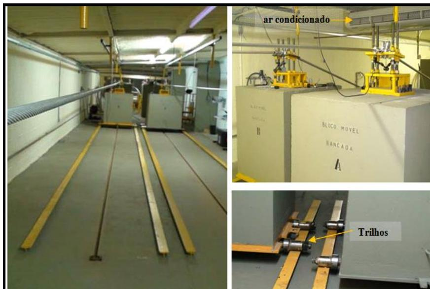
Figura 4.4 – Grampo de ancoragem montado em uma base de concreto com rolamentos e os trilhos.
