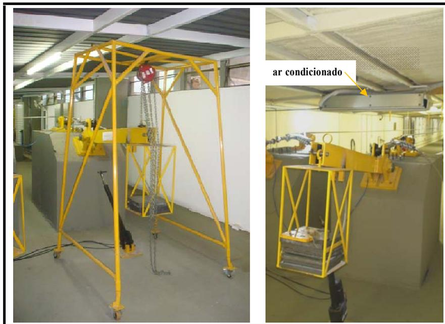
Figura 4.6 – Bloco fixo 3 que contém os dispositivos para controle de tração do cabo.
