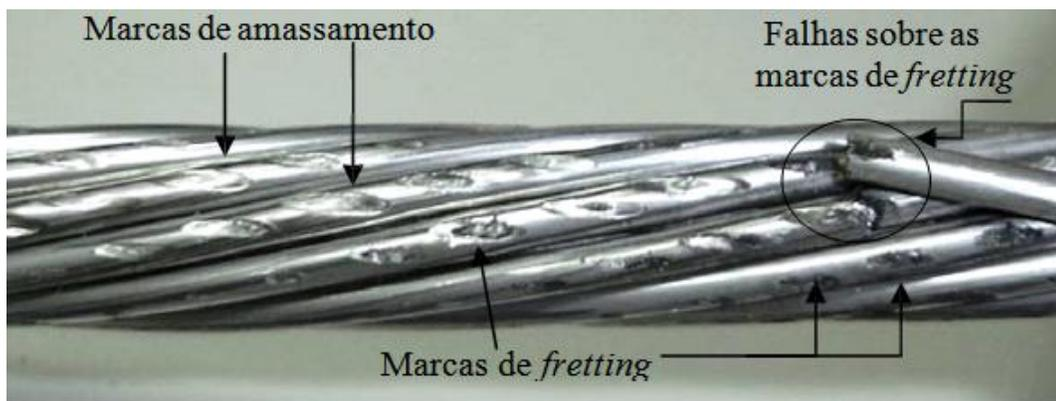
Figura 1.1– Foto de amostra de cabo ACSR, evidenciando regiões de contato e desgaste.
