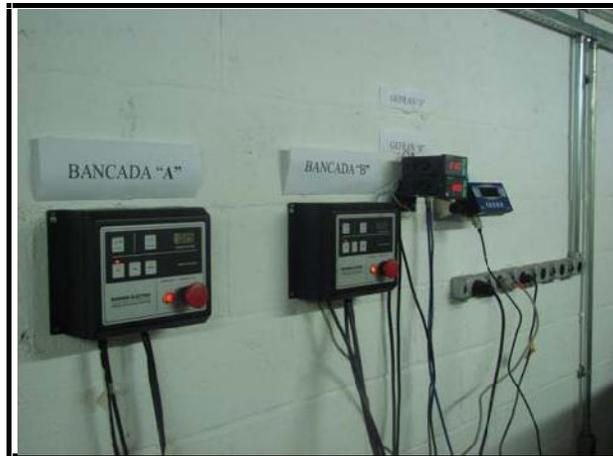
Figura 4.7 – Painel de controle do atuador hidráulico para controle da EDS.
