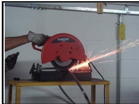
Figura 4.25 – Corte do corpo de prova utilizando uma máquina policorte.
