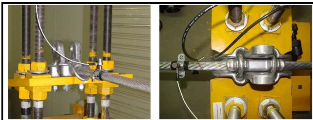
Figura 4.12 – Montagem cabo/grampo vista de frente e de topo.
