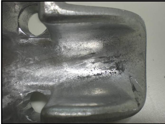
Figura 5.47 – Pó de  $\text{Al}_2\text{O}_3$  na vizinhança da boca do grampo de suspensão após retirada da amostra 23.
