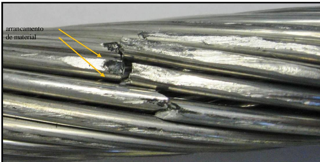
Figura 5.55– Quebras na base da camada externa da amostra 8.
