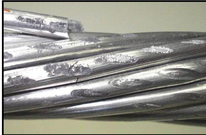
Figura 5.48 – Quebras nas camadas internas sobre as marcas de elípticas de *fretting*, amostra 10.
