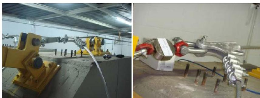
Figura 4.3– a) Fixação do cabo através do grupo de ancoragem passante no bloco fixo 3, b) Detalhe do grupo de ancoragem passante e a célula de carga.
