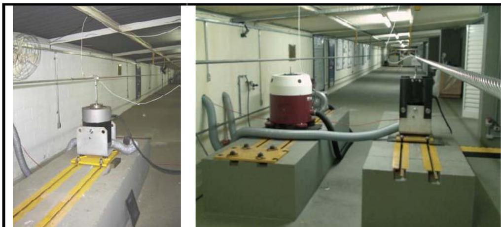
Figura 4.5 – Bloco fixo com trilho para deslocamento do *shaker* e bancada duplicada.
