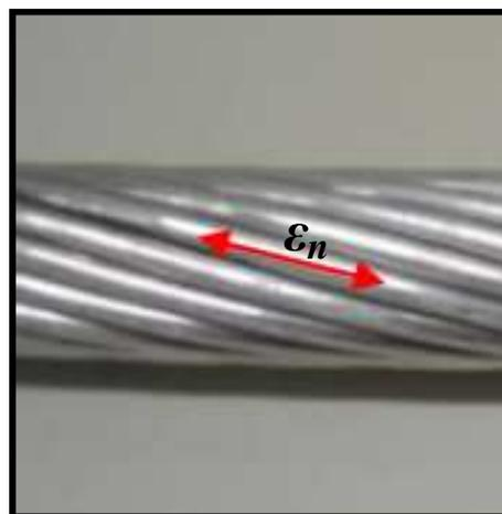
Figura B3– Deformação linear do cabo.
