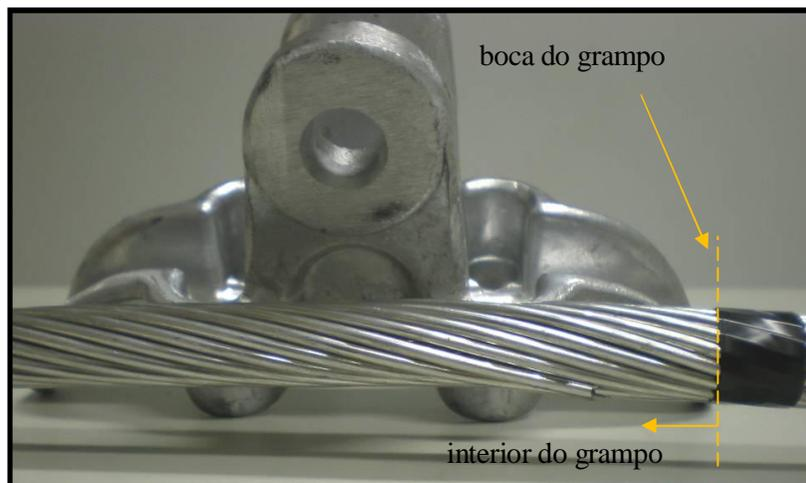
Figura 5.46 – Posição da falha em relação ao grampo de suspensão na amostra 23.
