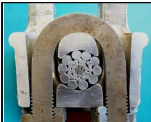
Figura 4.18 – Vista em corte da montagem de um cabo condutor/grampo de suspensão (PLP, 2008)
