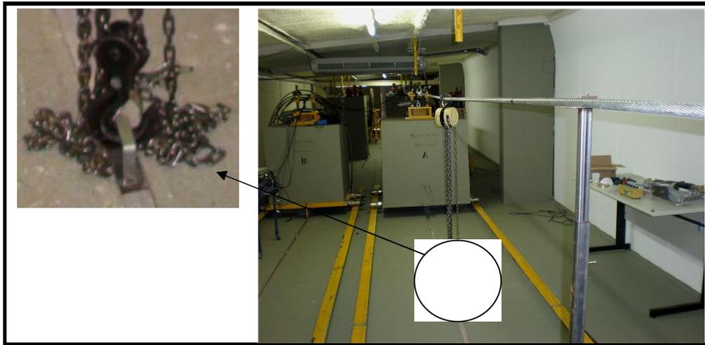
Figura 4.29 – Colocação de um apoio no nó para realização de ensaio estático tipo (a).
