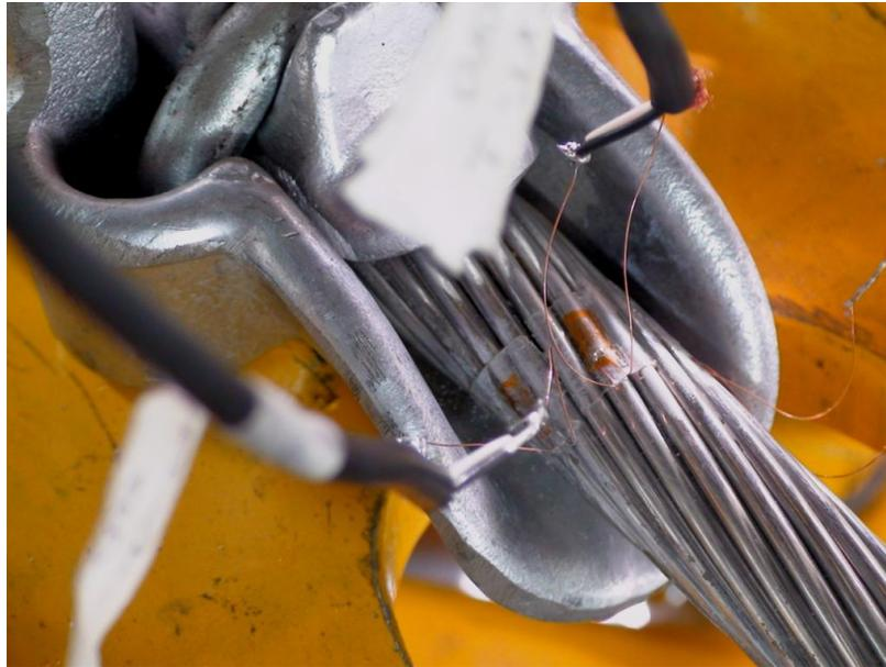
Figura 4.36 – Extensômetro colado no cabo ainda sob a fita adesiva.
