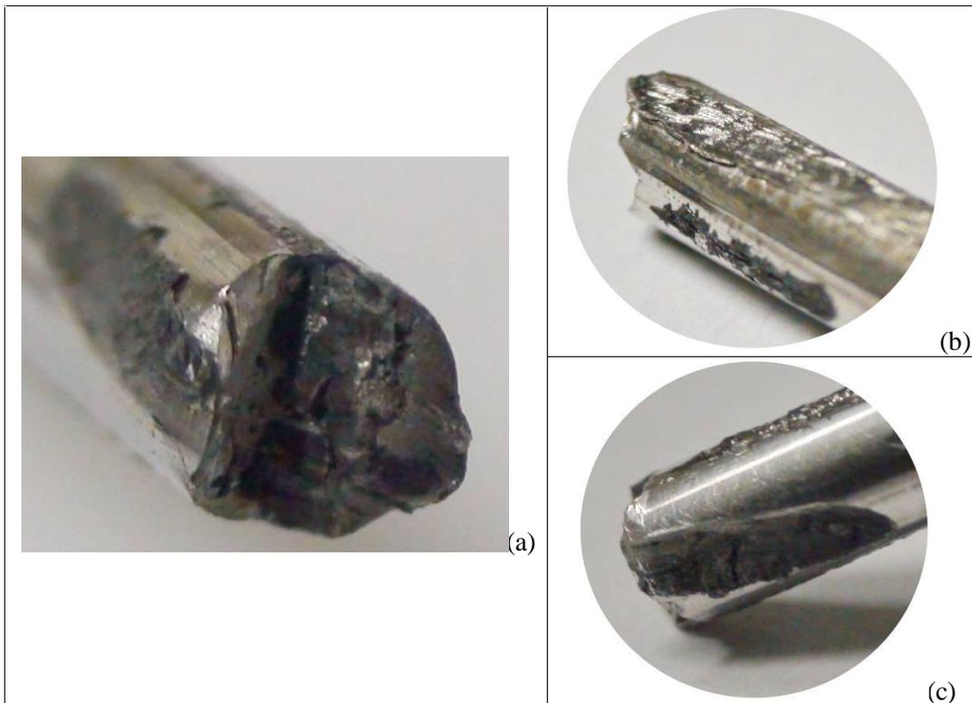
Figura 5.59 – Detalhe de falha em V na amostra 39
