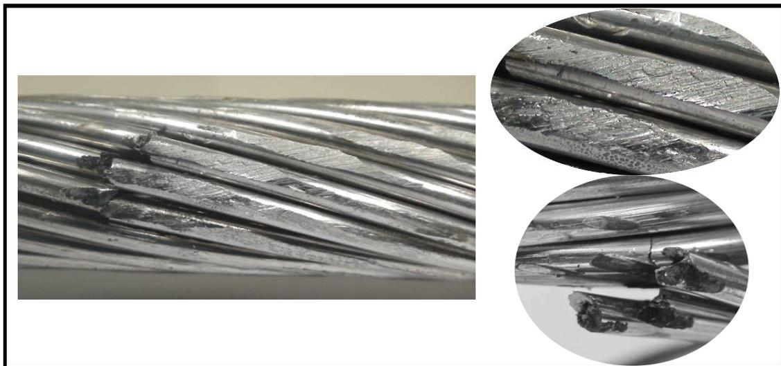
Figura 5.51 – Vista do desgaste e das três falhas externas na base da amostra 32.
