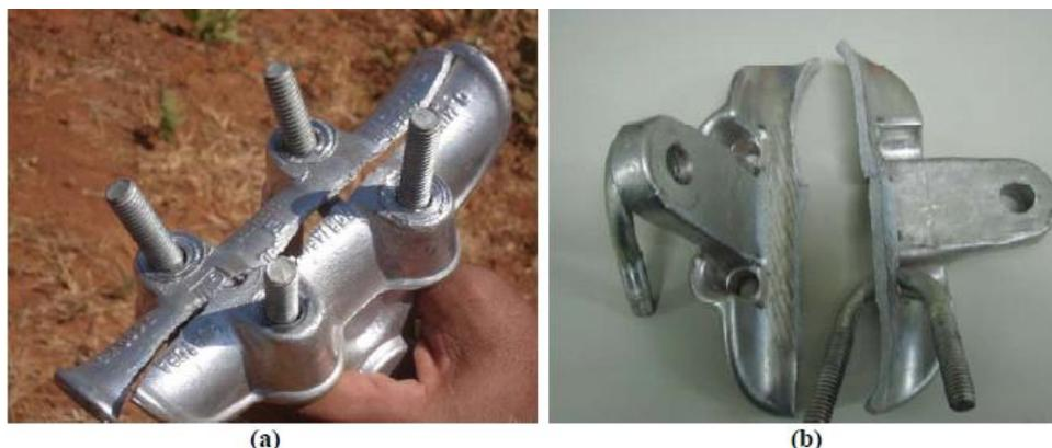
Figura 4.21 – Grampo de suspensão monoarticulado rompido após a aplicação do torque igual 60 Nm (Hortêncio, 2008).
