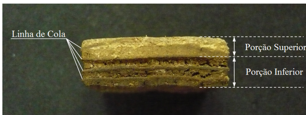
Figura 45. Vista lateral de um corpo-de-prova de LVL (CP) após o ataque do fungo Gloeophyllum trabeum (podridão parda) exemplificando a limitação do crescimento, basicamente na porção inferior do CP e em regiões afastadas da linha de cola.
