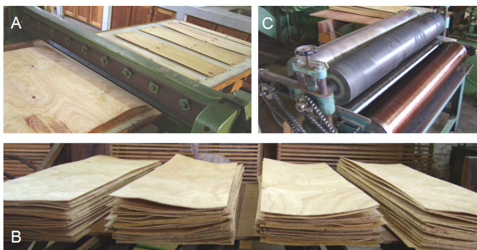
Figura 13. Processos de confecção dos painéis LVLs, onde: A- Processo de esquadreamento das lâminas para a confecção dos painéis LVLs; B- sorteio das lâminas que formaram cada painel LVL; C- Aplicador de adesivo de rolos.
