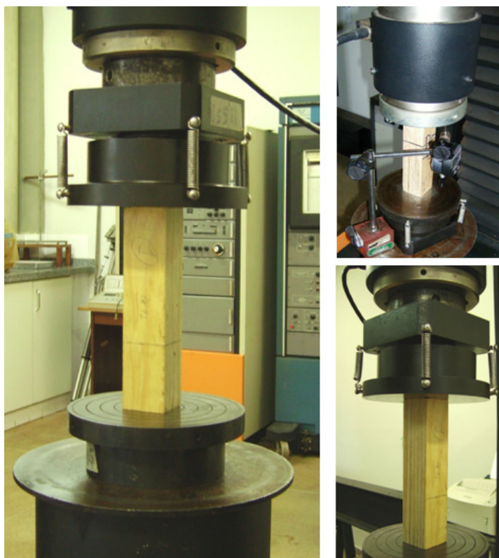
Figura 16 Realização do ensaio de resistência à compressão paralela às fibras para os painéis LVLs confeccionados com Pinus oocarpa e Pinus kesiya .
