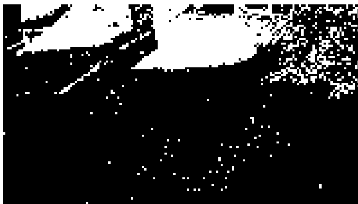
Figura 4.6: Exemplo de uma máscara gerada pela subtração de fundo afetada pelo ruído de aquisição.
