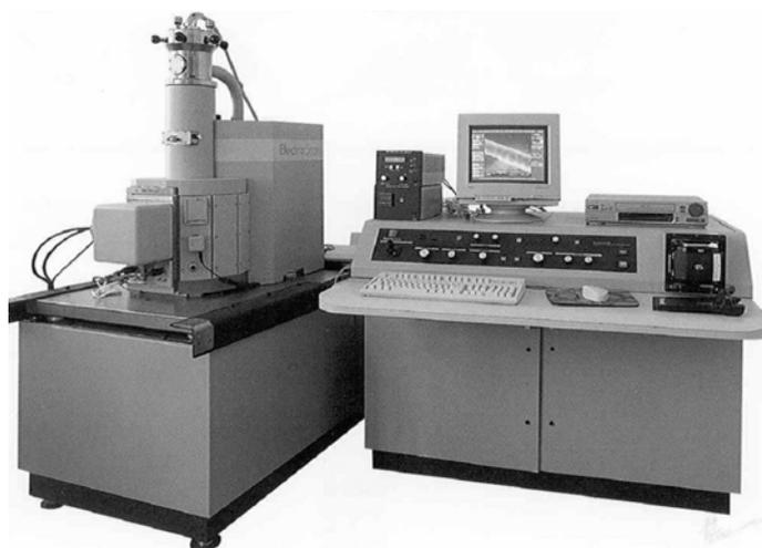
Figura 4.8. Microscópio Eletrônico de Varredura Ambiental Electrosan 2020.
