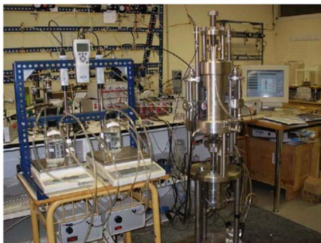
Figura 3.5. Traixial baseado no método de equilíbrio de vapor para ensaio com controle de sucção (Lima, 2007).
