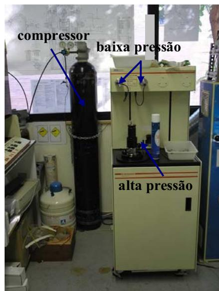
Figura 4.6. Porosímetro por intrusão de mercúrio Micromeritics.
