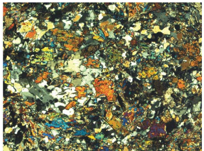
Figura II.7 – Fotomicrografias da lâmina IPC143 (Seqüência Maratá): Dacito. Metavulcânica félsica de granulação fina. Aumento de 4x luz, transmitida normal e polarizada (Bt: biotita; Ep: epidoto; Pl: plagioclásio; Qtz: quartzo; Ttn: Titanita).
