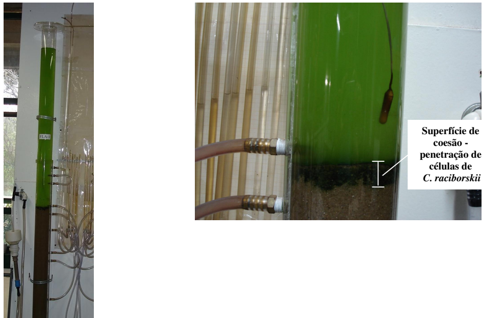
Figura 5.16 - Fotos dos filtros lentos durante a Fase 6 do Experimento 1: (a) FLA-1 atingindo o limite da perda de carga (b) Topo da camada filtrante do FLA-2 (superfície de coesão)
