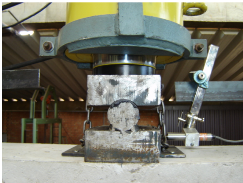
Figura 3.18 - Defletômetro elétrico no aparelho de apoio superior
