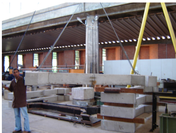
Figura 3.22 – Transporte do modelo para o pórtico
