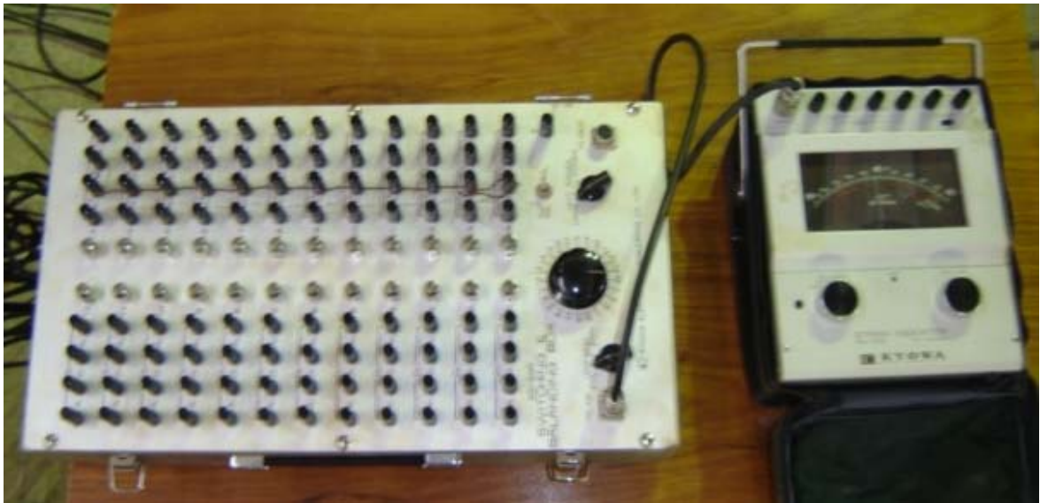
Figura 3.29 – Caixa comutadora e Indicador de deformações
