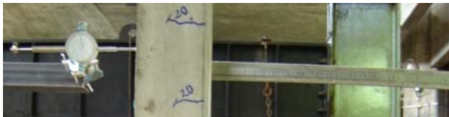
Figura 3.16 – Detalhe do defletômetro central e da régua de medição
