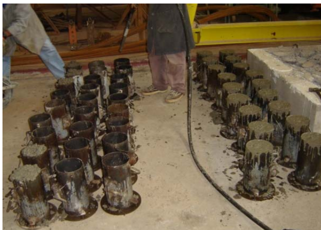
Figura 3.11 - Corpos-de-prova sendo moldados
