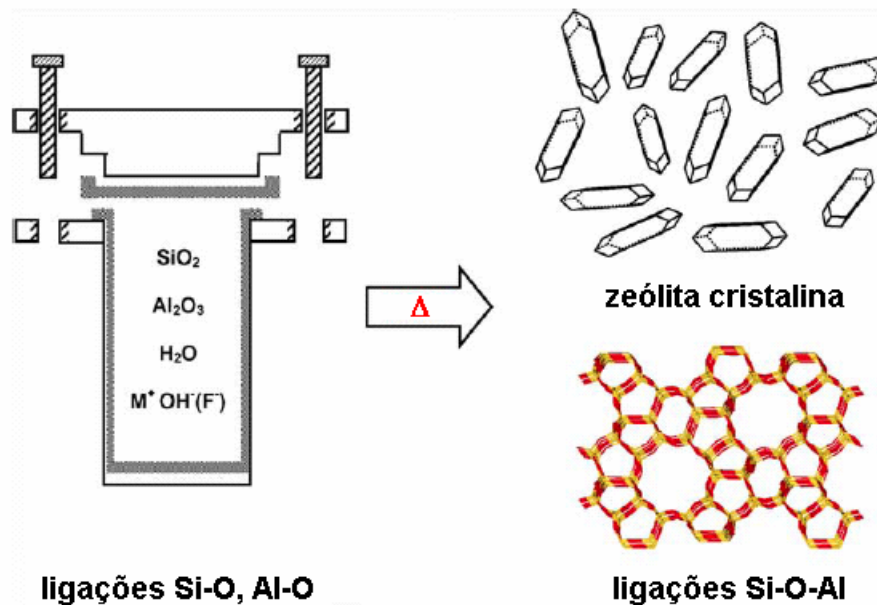
Figura 1: Síntese hidrotérmica de zeólitas: os materiais de origem (ligações Si-O e Al-O) são convertidos por um meio aquoso mineralizante ( \text{OH}^- e/ou \text{F}^- ) no produto cristalino (ligações Si-O-Al) cuja microporosidade é definida pela estrutura. 3,8
