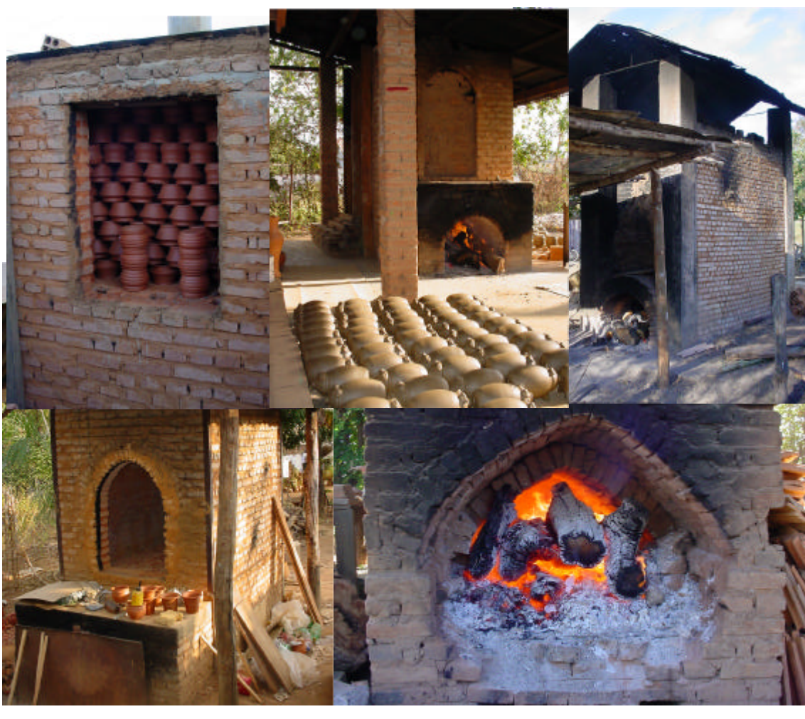
Figura 3.2.1.2: Tipos de fornos utilizados pelos ceramistas
