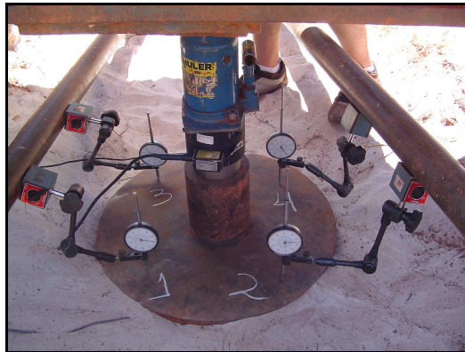
Figura 3.42 – Segundo carregamento do grupo de quatro estacas.
