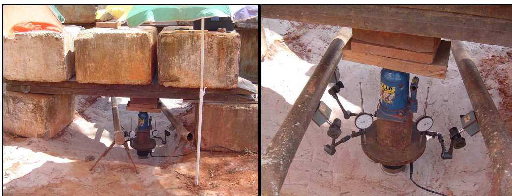
Figura 3.36 – Prova de carga na estaca A 1 .
