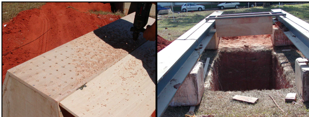
Figura 3.7 - Caixa de madeira (de cabeça para baixo com tampa falsa) e trilhos.
