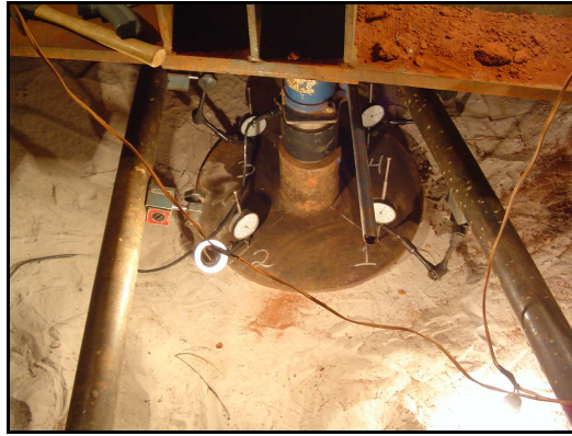
Figura 3.38 – Prova de carga no grupo de quatro estacas.
