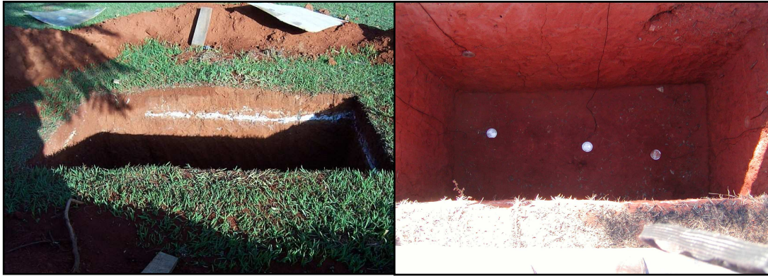
Figura 3.6 – Vala e células de pressão total.
