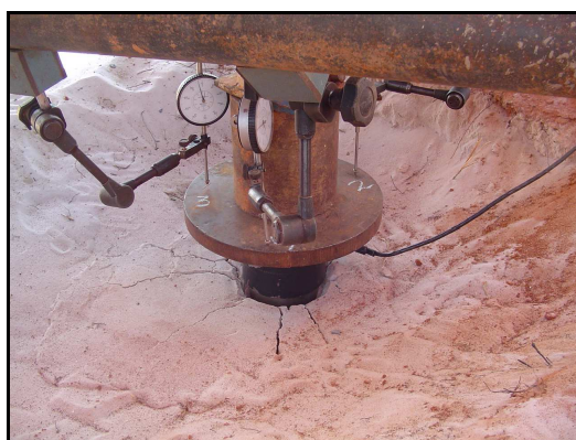
Figura 3.37 – Ruptura da estaca A 1 .
