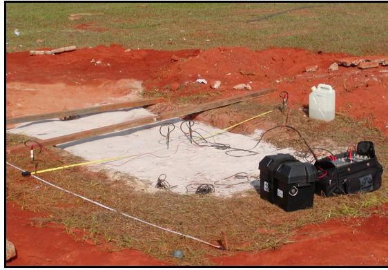
Figura 3.49 – Aquisição das medidas de resistividade.
