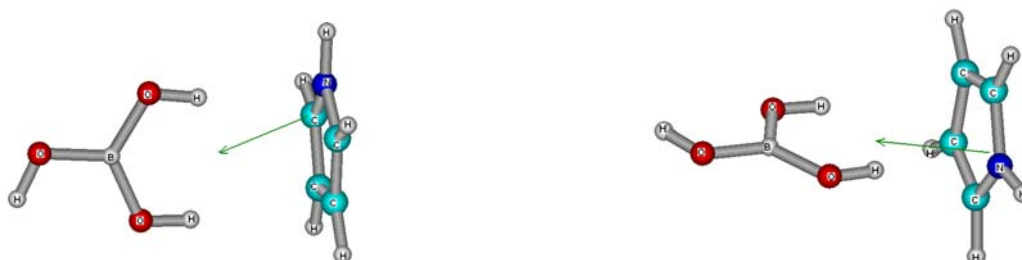
Ilustração 116. Direção do vetor momento de dipolo no par molecular ácido bórico e pirrol observado por duas perspectivas diferentes
