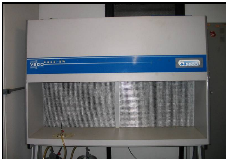
Figura 3.14: Câmara de fluxo laminar para análise microbiológica (Capela).
