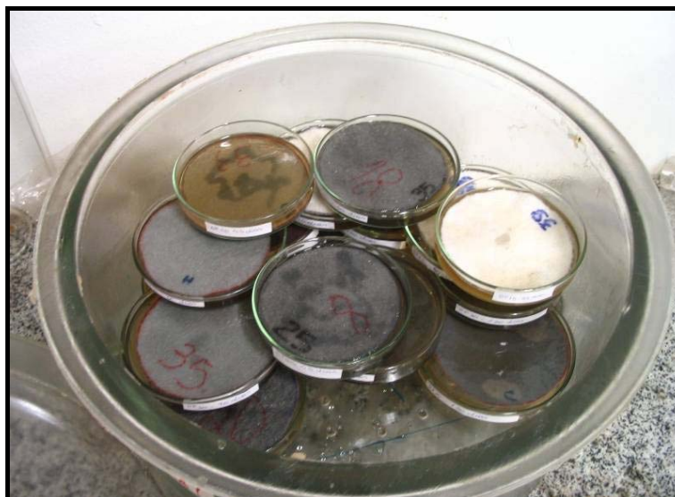
Figura 3.6: Recipiente utilizado no ensaio de colmatação por imersão.
