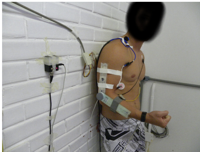
Figura 23 - Eletrogoniômetro acoplado ao microprocessador.
