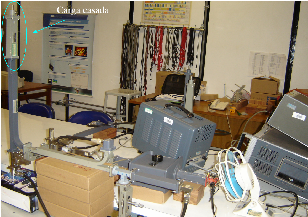
Figura 9.1- Em detalhe a carga casada na porta de teste do circuito seis-portas.
