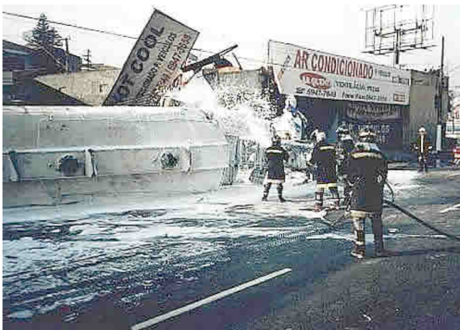
Figura 2.9: Colisão seguida de capotamento com carreta transportando álcool e aplicação de espuma.
