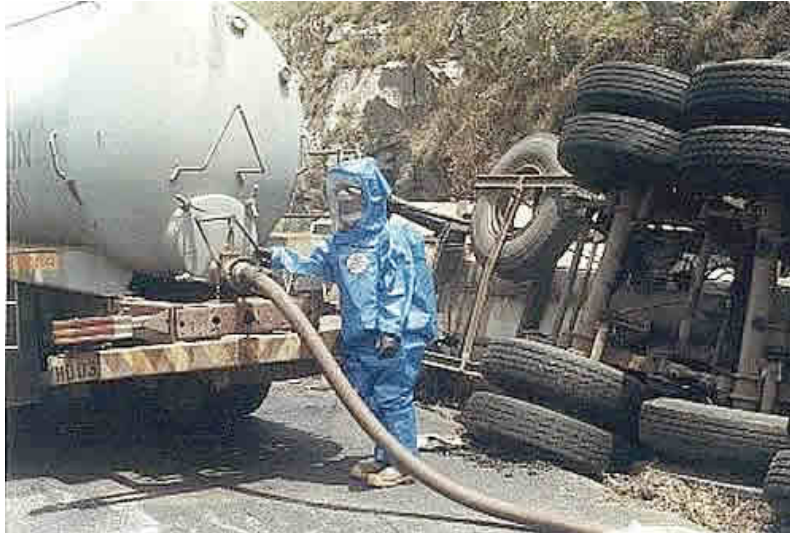
Figura 2.11: Acidente envolvendo a atividade de transbordo de produto químico perigoso, em que se nota a utilização do EPI pelo profissional de atendimento emergencial.
