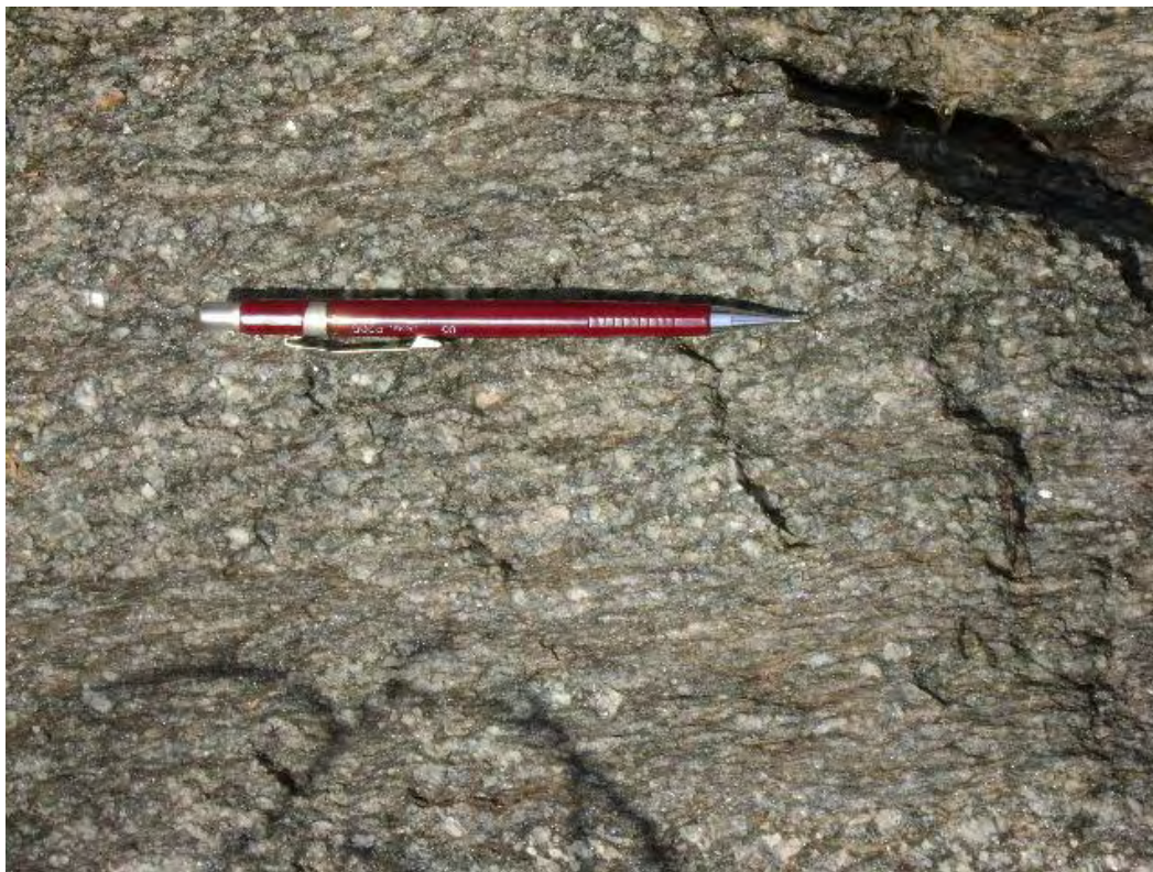
Figura 3.3 - Biotita paragnaisse milonítico onde podem ser observados fenoclastos de plagioclásio (Amostra PM-251, ver geoquímica).
