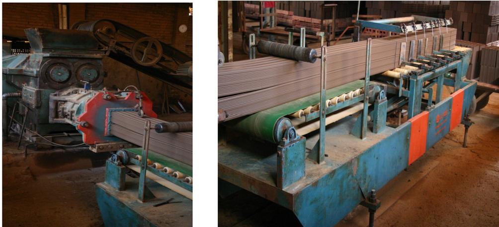
Figura 2.12 – Extrusora utilizada em uma indústria cerâmica situada em Campo Limpo/GO
