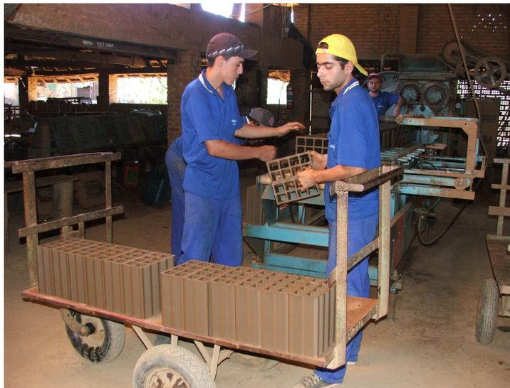
Figura 5.2 – Fabricação do pré produto na saída da extrusora
