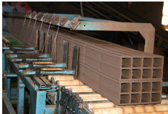
Figura 2.13 – Máquina de corte de uma indústria cerâmica situada em Campo Limpo/GO
