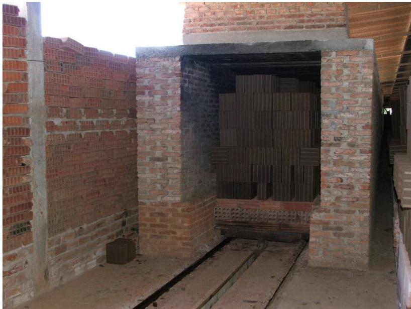
Figura 2.18 – Forno contínuo tipo túnel
