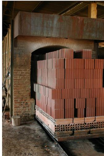
Figura 2.15 – Sinterização do bloco cerâmico em uma indústria de Campo Limpo/GO
