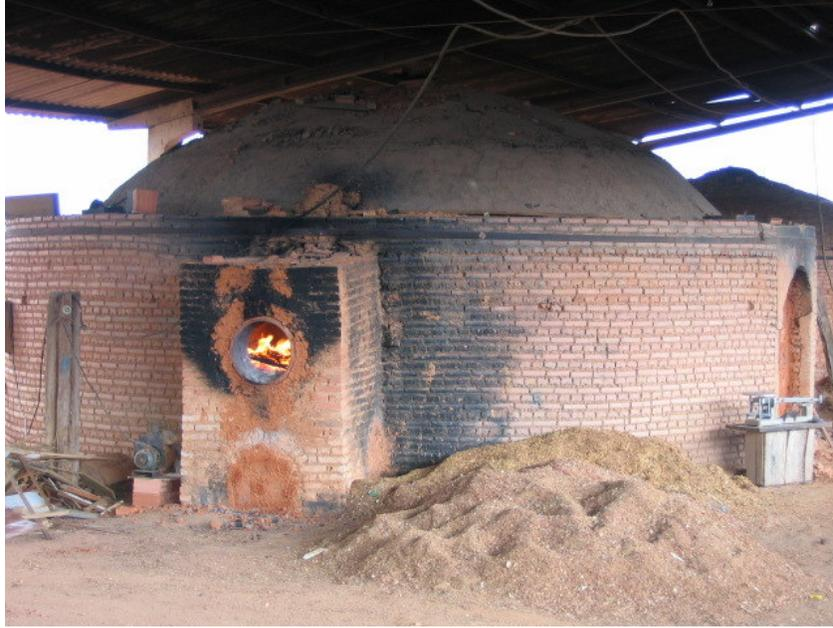
Figura 2.16 – Forno intermitente tipo abóbada
