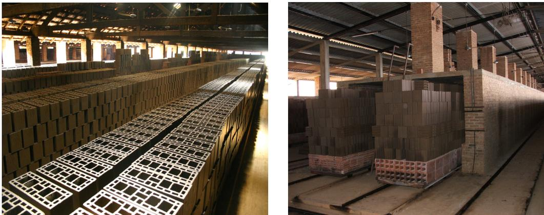
Figura 2.14 – Secagem: a) Natural realizada por meio de ventiladores; b) artificial feita por secadores em uma indústria cerâmica em Campo Limpo/GO
