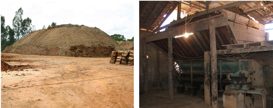
Figura 2.8 – Matéria-prima (argila): a) depósito e sazonalamento; b) silo para indústria de cerâmica vermelha, situada em Campo Limpo/GO
