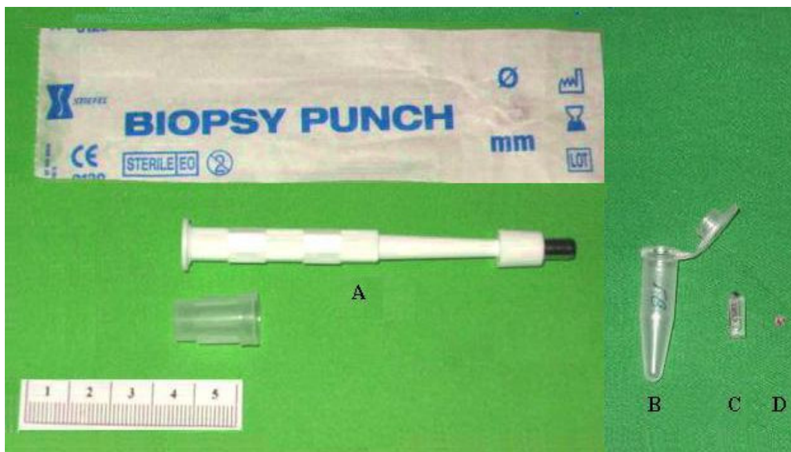
FIGURA 7 – MATERIAIS UTILIZADOS NA COLETA E PREPARO DAS AMOSTRAS PARA MICROSCOPIA ELETRÔNICA: EXTRATOR DE BIOPSIAS (A), EPPENNDORF (B), BLOCO EM RESINA (C) COM MATERIAL JÁ INCLUIDO E TELA DE COBRE (D)
