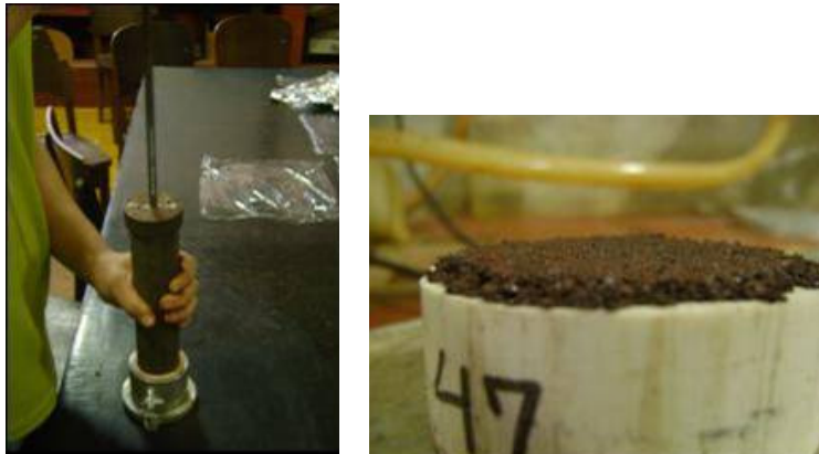
Figura 4.8. Detalhe da compactação realizada com martelo Marshall.
