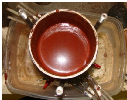
Figura 4.20. Minério no interior do permeâmetro.
