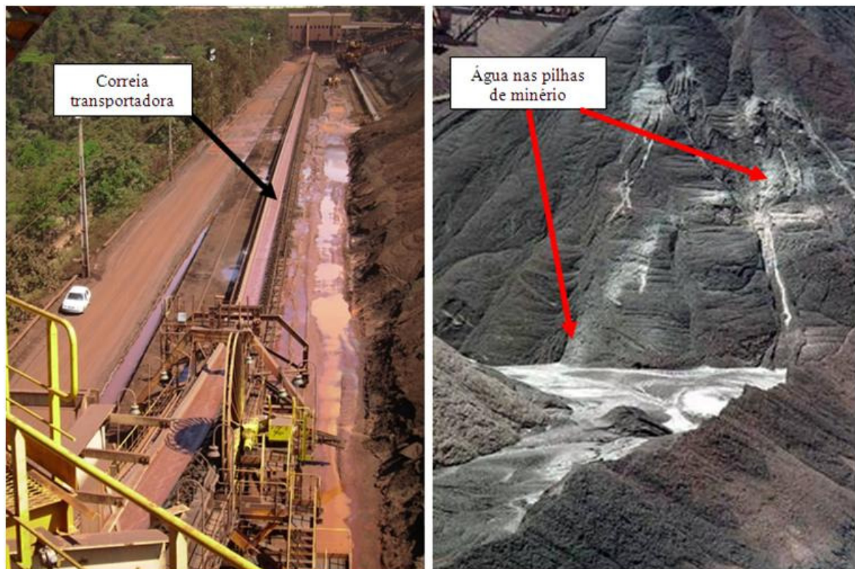
Figura 2.3. Correia transportadora e umidade da pilha de minério.
