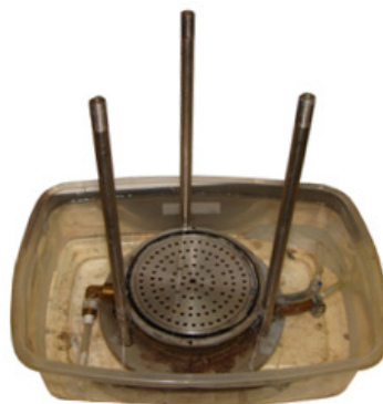
Figura 4.16. Parte inferior do permeâmetro submersa em água destilada.
