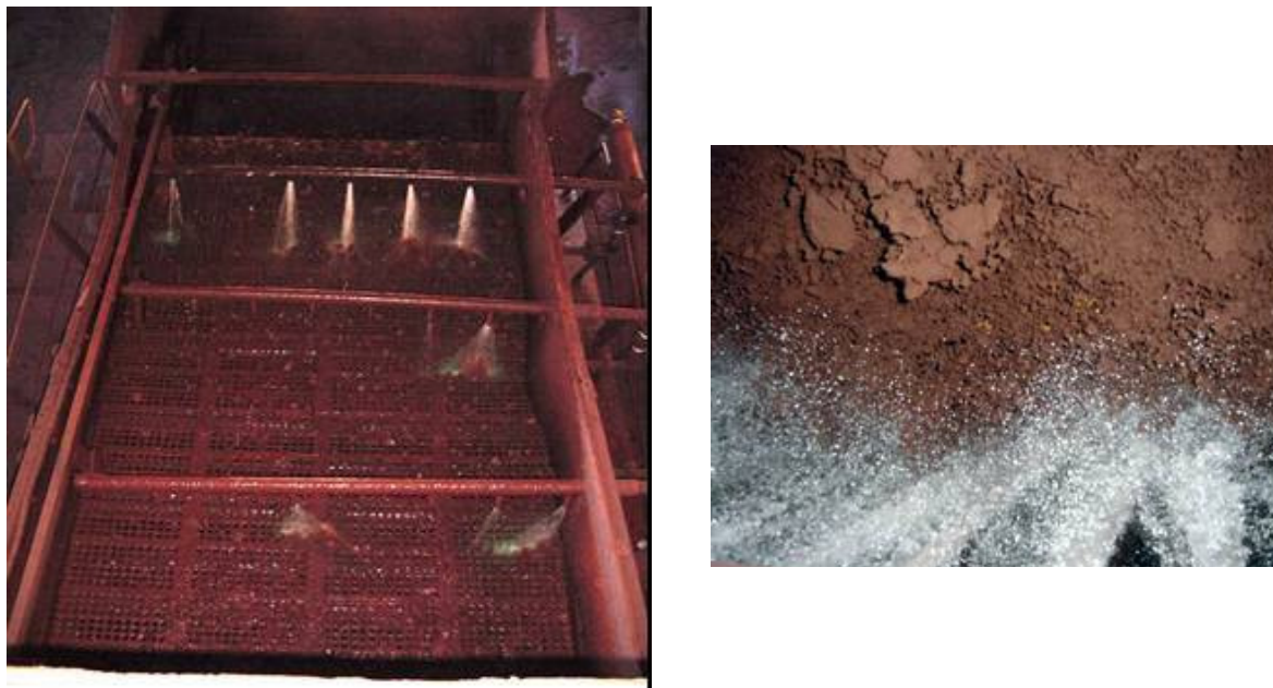
Figura 2.2. Processo de peneiramento do minério por via úmida.
