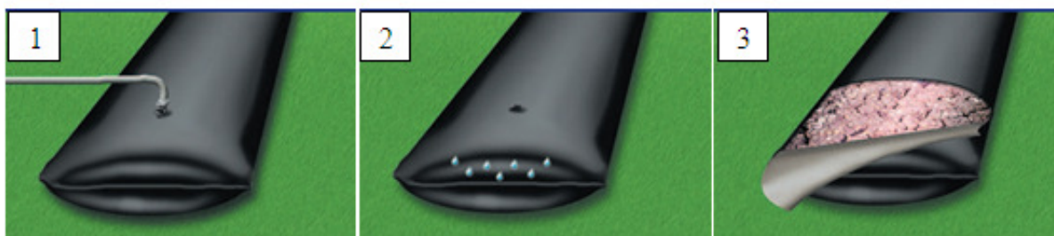
Figura 2.14. Enchimento, desidratação e consolidação de rejeito em tubos geotêxteis (modificado - Allonda, 2009).
