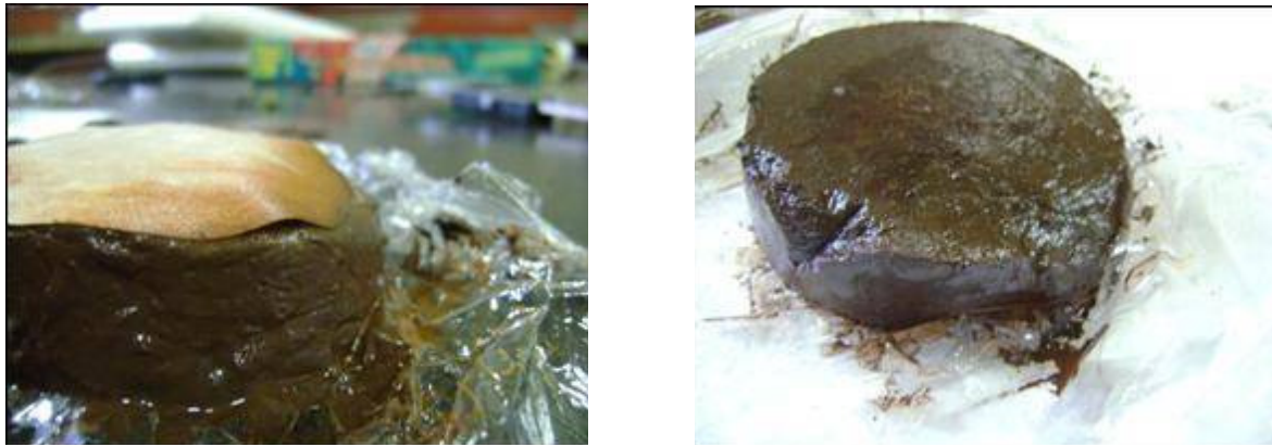
Figura 4.10. Deformação e perda de consistência das amostras com saturação elevada.
