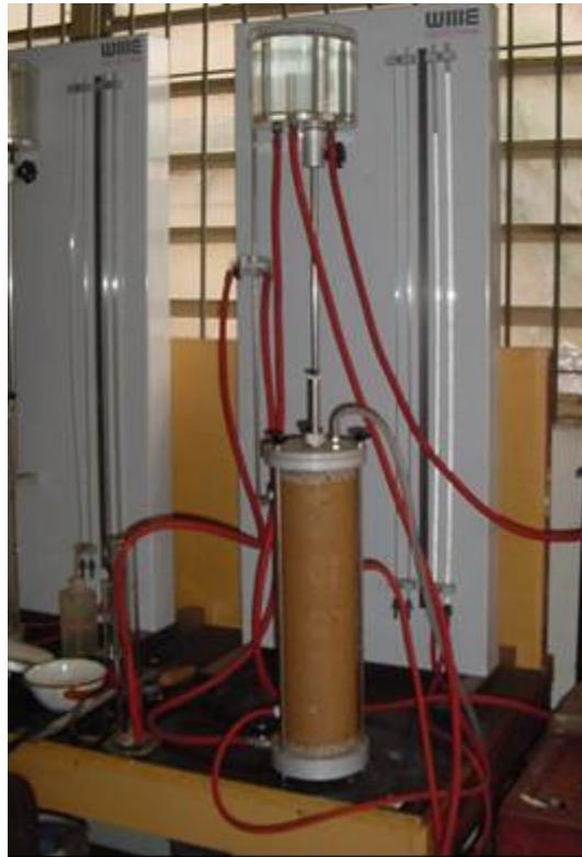
Figura 4.3. Ensaio de permeabilidade à carga constante – SFCJ.
