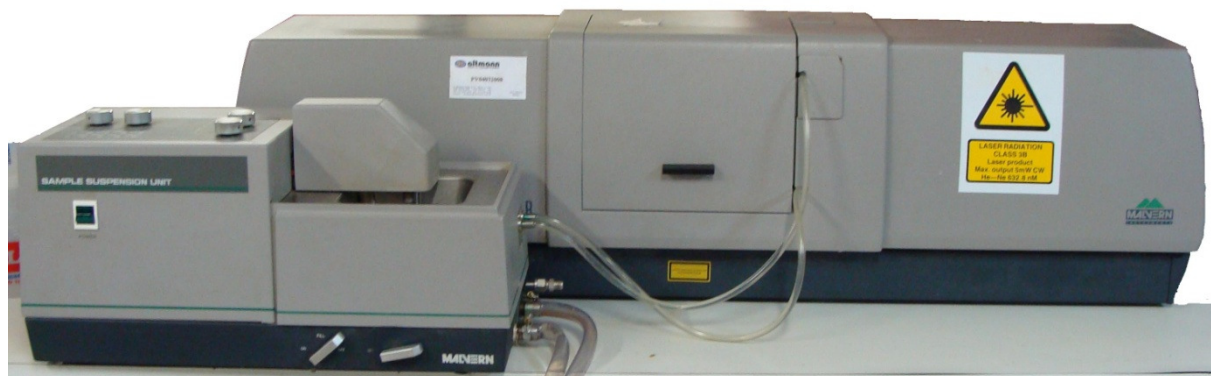
Figura 4.1. Unidade óptica e de preparação da amostra do granulômetro a laser.
