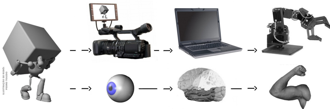
Figura 78 – Analogia do sistema de visão humano e computacional.
