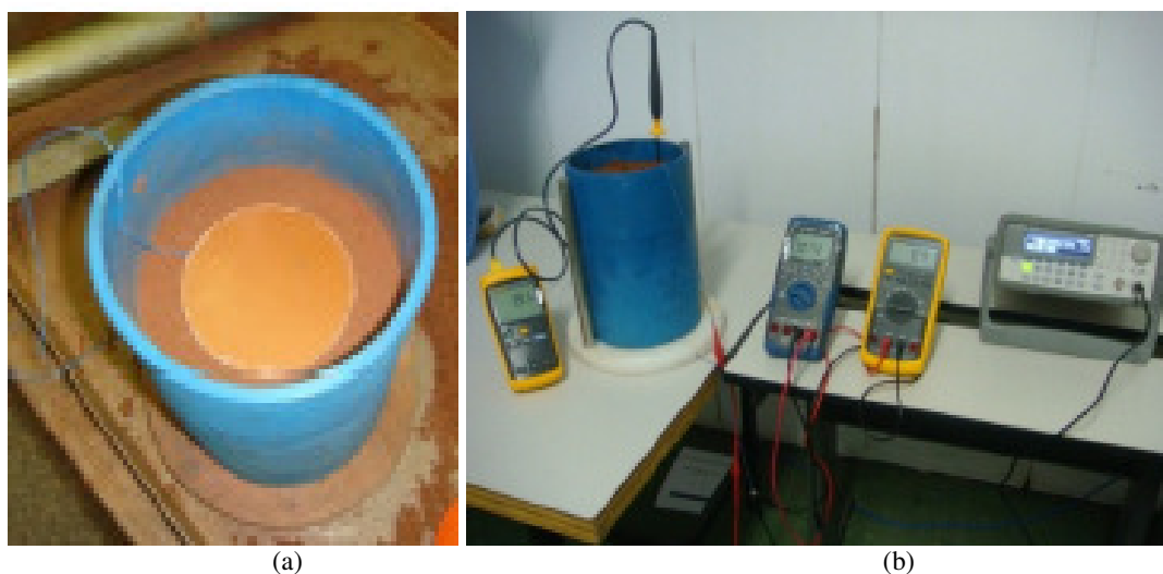
Figura 2.9 Configuração do ensaio realizado com as placas de cobre (PEIXOTO et al. , 2010 e YAMASAKI et al. , 2010): a) molde de compactação, b) aparato de medida montado.
