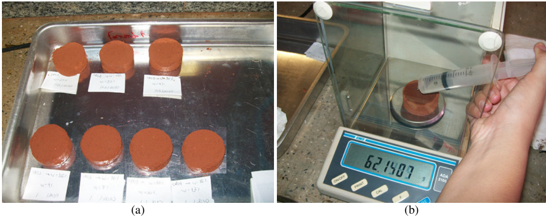
Figura 3.15 Preparação dos corpos de prova para ensaio de papel filtro: a) secagem ao ar, b) umedecimento por gotejamento.
