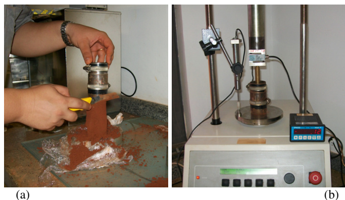
Figura 3.21 Ensaio de mini-CBR: a) cravação do cilindro metálico, b) penetração do pistão.
