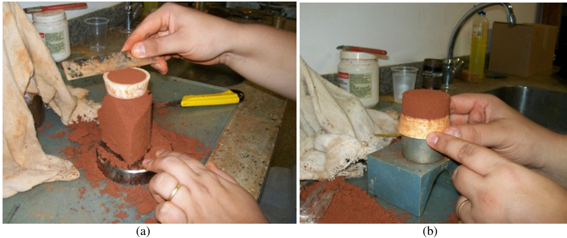
Figura 3.14 Moldagem dos corpos de prova para secagem e umedecimento: a) cravação do cilindro de PVC, b) desmoldagem dos corpos de prova do cilindro de PVC.
