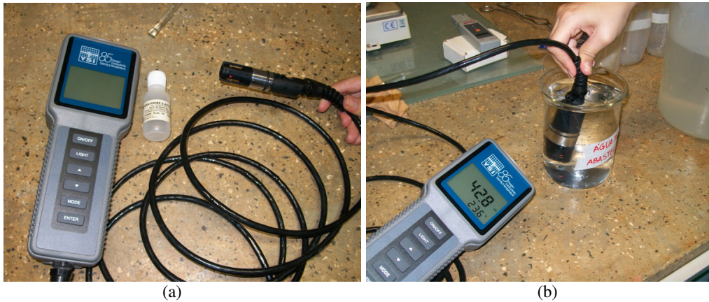
Figura 3.7 Medida de condutividade elétrica da água: a) equipamento, b) medida.
