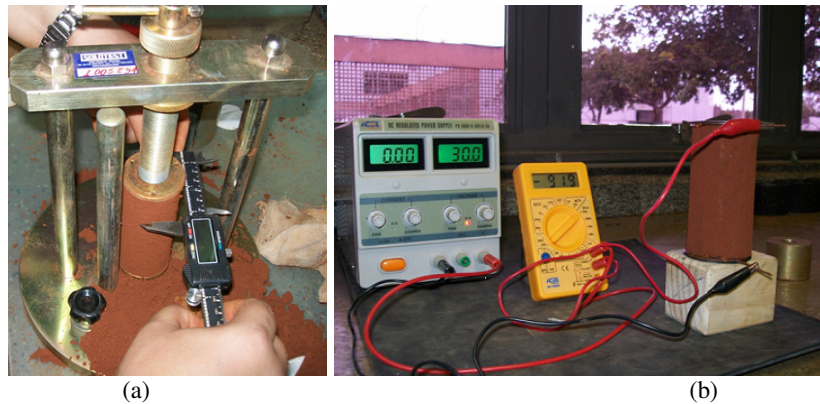
Figura 3.20 Preparação dos corpos de prova para ensaio triaxial cíclico: a) aferição de dimensões, b) medida de resistividade elétrica.
