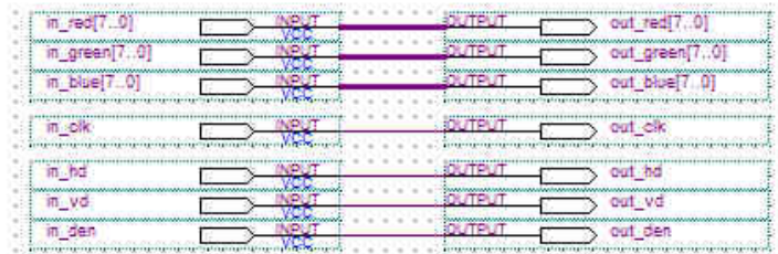
Figura 6.4 – Arquitetura da IPU sem qualquer tipo de processamento.
