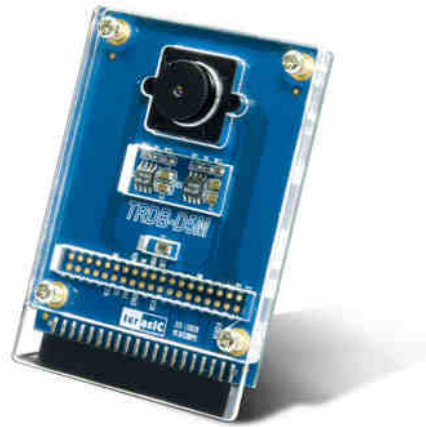
Figura 4.3 – Câmera modelo TRDB_D5M (Terasic Inc.).
