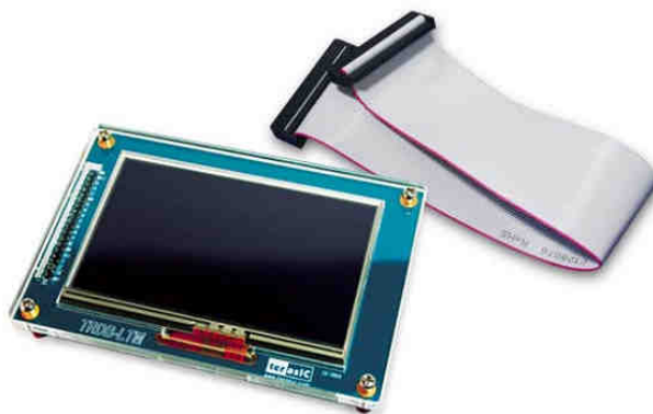
Figura 4.4 – Display LCD, modelo TRDB_LTM (Terasic Inc.).
