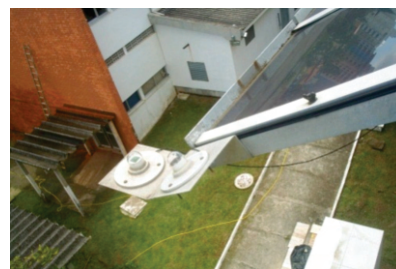
Figura 20 - EQUIPAMENTOS DE SOLARIMETRIA DISPOSTOS NA COBERTURA DO LABSOLAR. Acervo Particular
