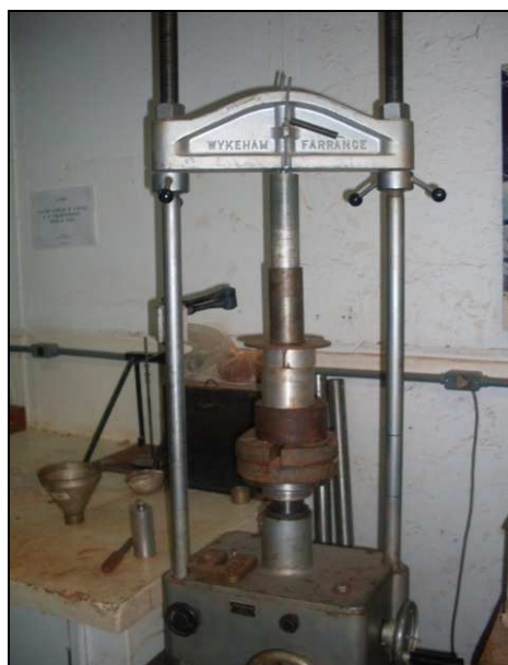
Figura 3.14. Compactação semi-estática na prensa do corpo de prova.
