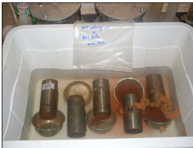
Figura 3.12. Ensaio de perda por imersão com a amostra AN20.
