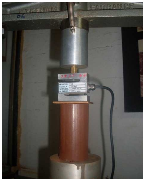
Figura 3.23. Detalhe do corpo de prova recebendo o carregamento.
