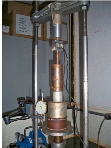
Figura 3.17. Ensaio de Mini-CBR com a amostra ANtotal.
