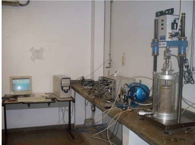
Figura 3.25. Etapas do Ensaio de Módulo de Resiliência no LER. (a) Soquete grande, base do cilindro, cilindro (10 x 20 cm); (b) Compactação do CP; (c) Extração do CP; (d) CP no interior da célula do triaxial e envolto pela membrana de borracha; (e) visão panorâmica do conjunto necessário para o ensaio de módulo de resiliência.
