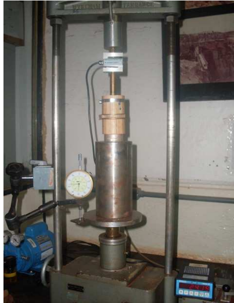
Figura 3.18. Ensaio de Mini-CBR com corpos de prova das misturas.
