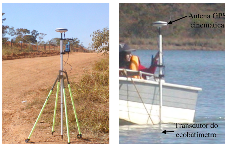
Figura 3.10 - (a) Estação GPS fixa e (b) Estação GPS móvel usadas nos levantamentos.
