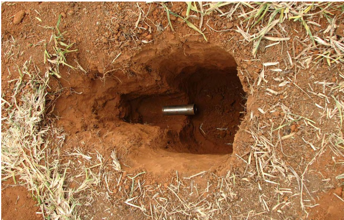
Figura G.4. Determinação do perfil de massa específica das amostras coletadas para as medidas do teor de ^{137}\text{Cs} .
