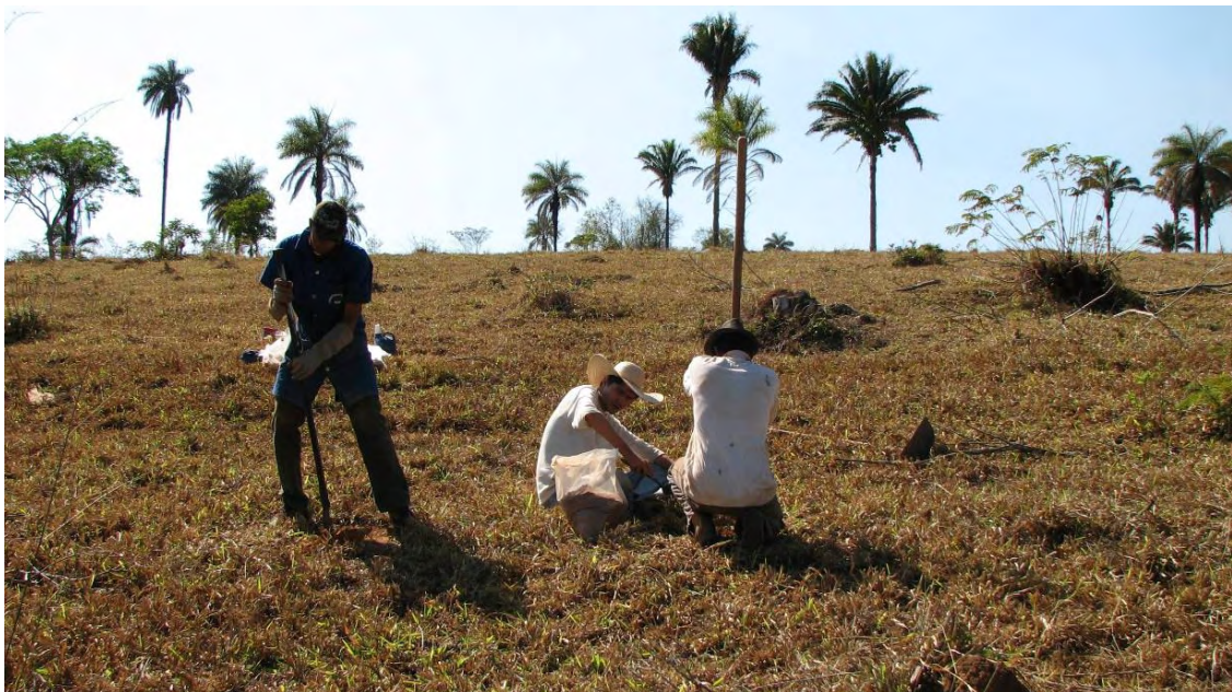
Figura G.2. Coleta de amostras, em área de pastagem, para a realização de ensaios de medidas do teor de ^{137}\text{Cs} (ponto C04).
