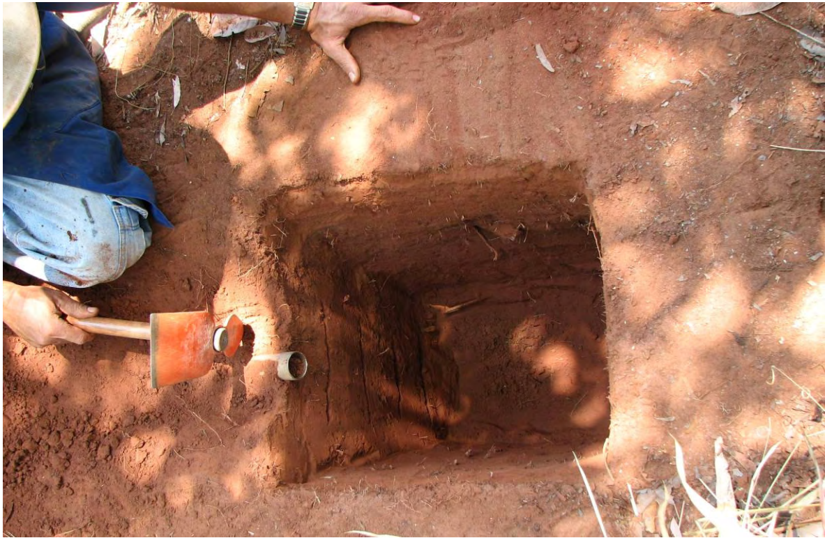
Figura G.3. Determinação do perfil de massa específica das amostras coletadas para as medidas do teor de ^{137}\text{Cs} .
